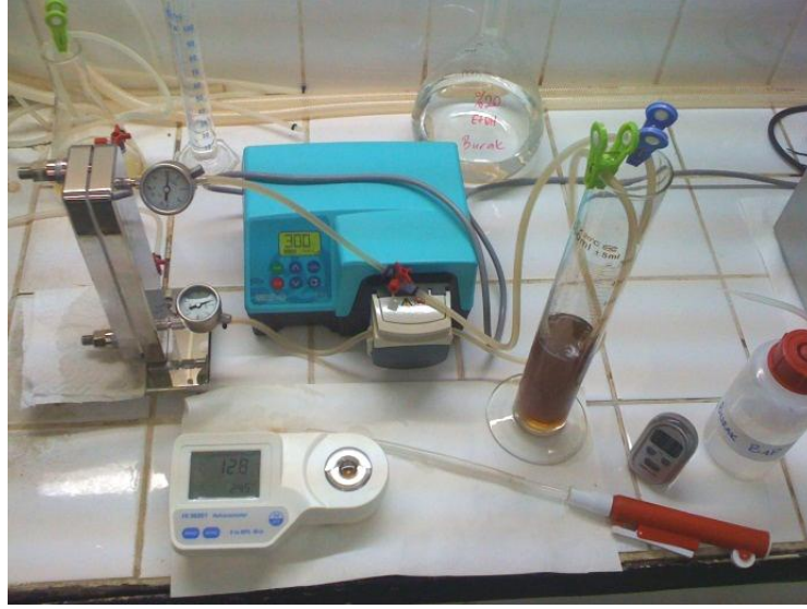
Şekil 3. 3. Ön konsantrasyon amacıyla uygulanan ultrafiltrasyon sistemi
