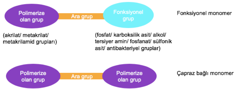
Şekil 2-1: Adeziv Sistemlerde Kullanılan Monomerlerin Temel Yapısı
