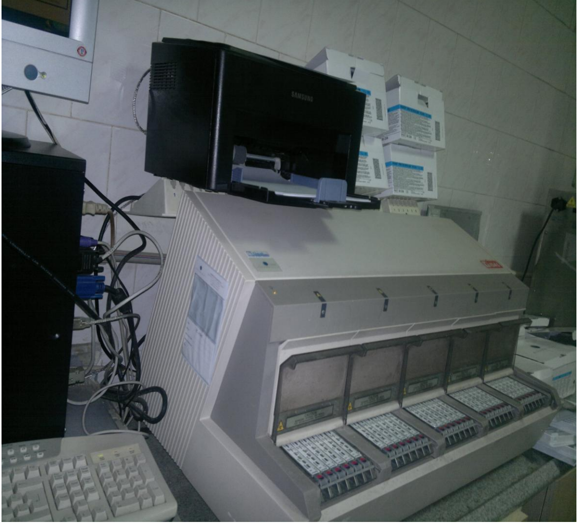
Resim 5. ELFA yöntemi ile çalışan Biomeriux Vidas PC Cihazı
