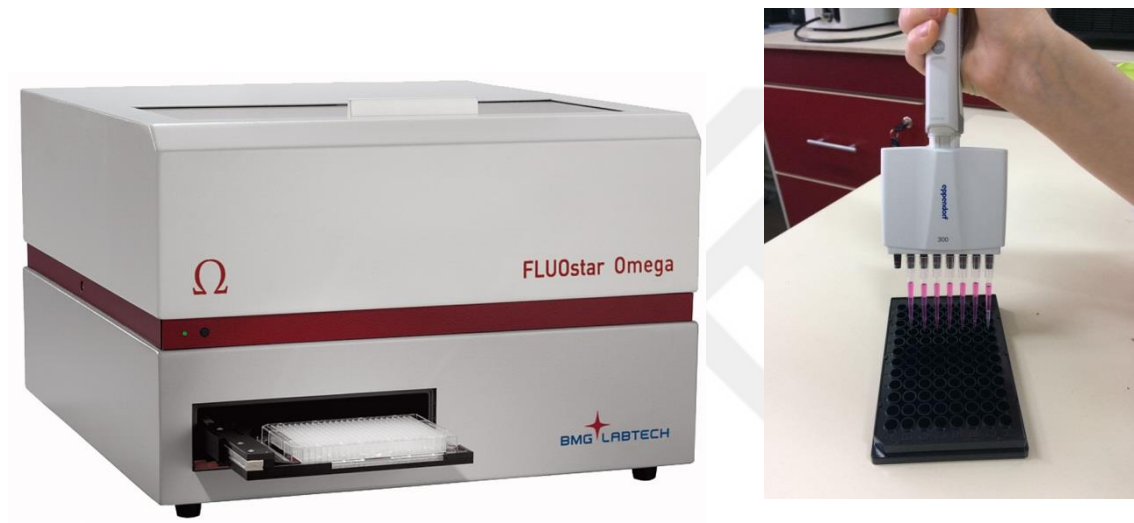
Şekil 3.1. FLUOstar Omega immünoassay cihazı ve 96 kuyucuklu polistiren opak plate.
