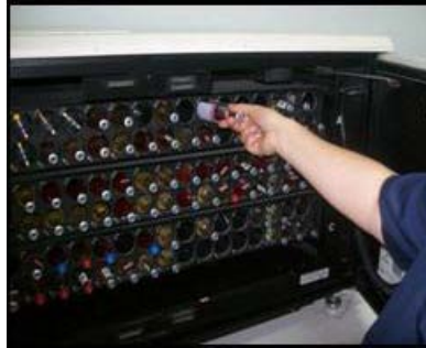
Şekil 2.15. Kültür tüpünün cihazın inkübasyon bölümüne yerleştirilmesi
