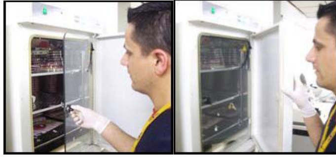
Şekil 2.10. Etüv iç cam kapak ve dış kapağının kapatılması
