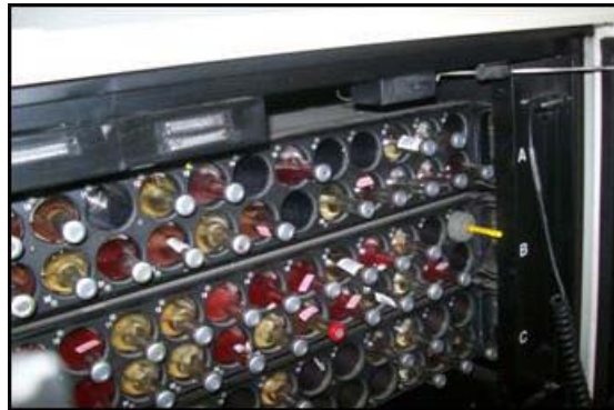
Şekil 2.13. Otomatik kan kültür cihazının inkübasyon bölümü
