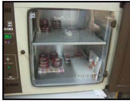
Şekil 2.5. Etüve plak besiyerlerinin yerleştirilmesi
