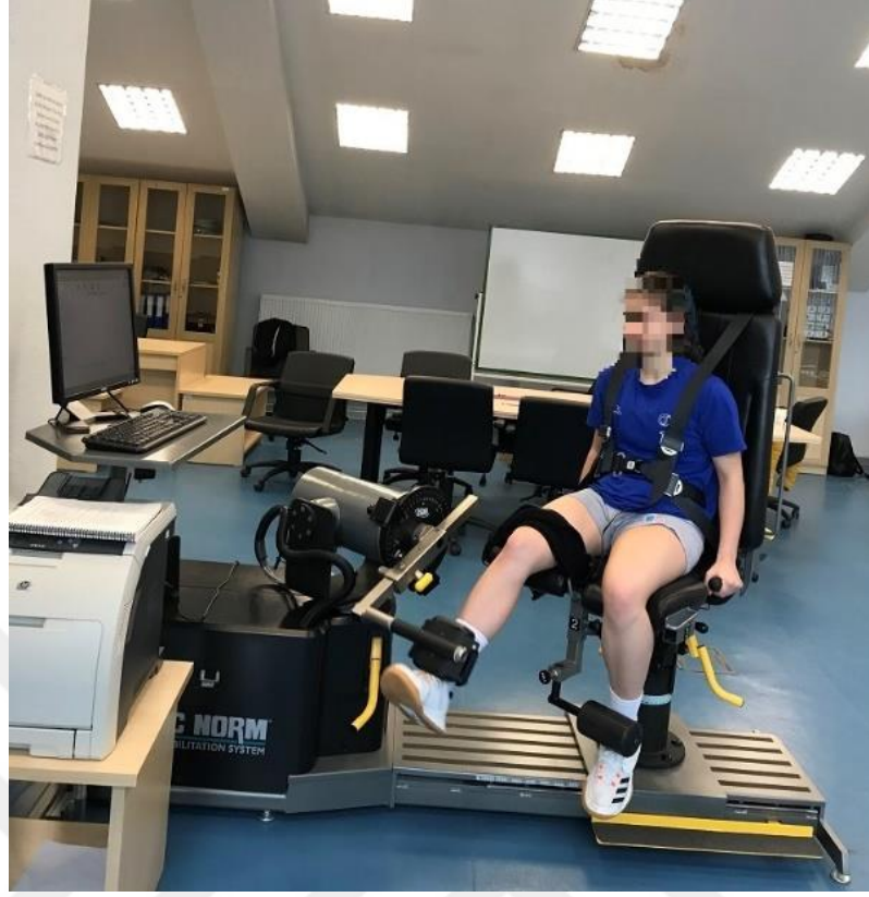
Görsel 3.9. İzokinetik diz eklemi kuvveti ölçümü uygulaması
