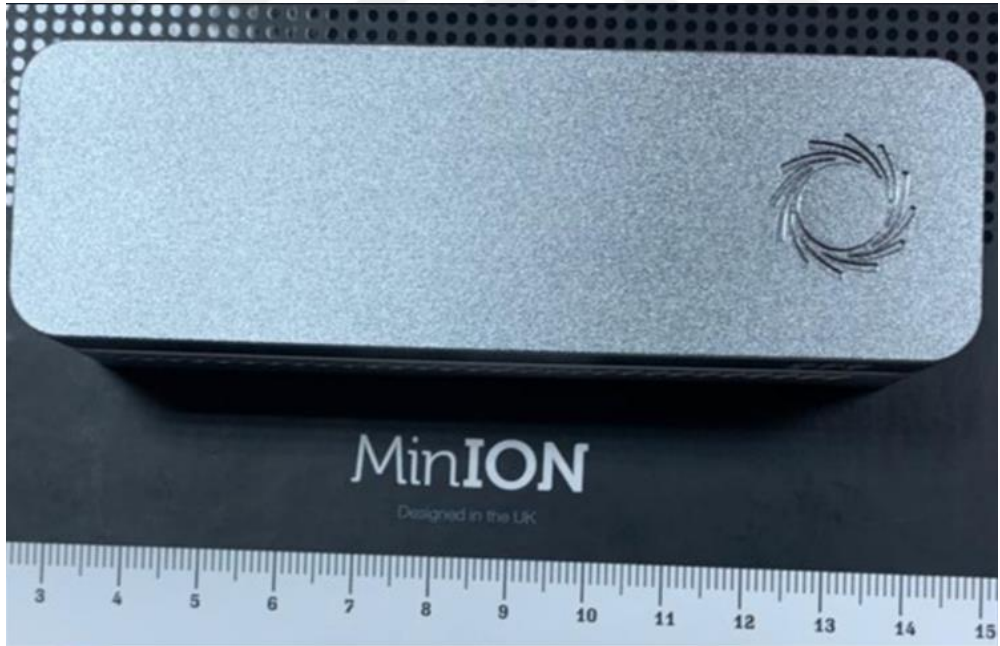
Resim 3.6.3. Minion yeni nesil sekans cihazı (Oxford Nanopore Technologies, İngiltere)
