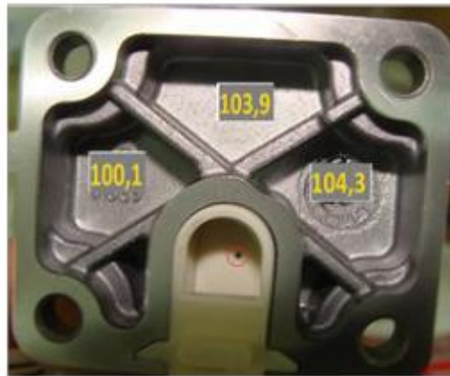
Şekil 3.24: Egzoz plenumu sıcaklıkları.
