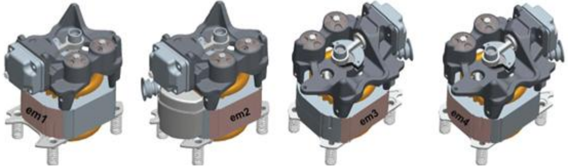
Şekil 2.9: Elektrik motorundaki ölçüm alanları [13].
