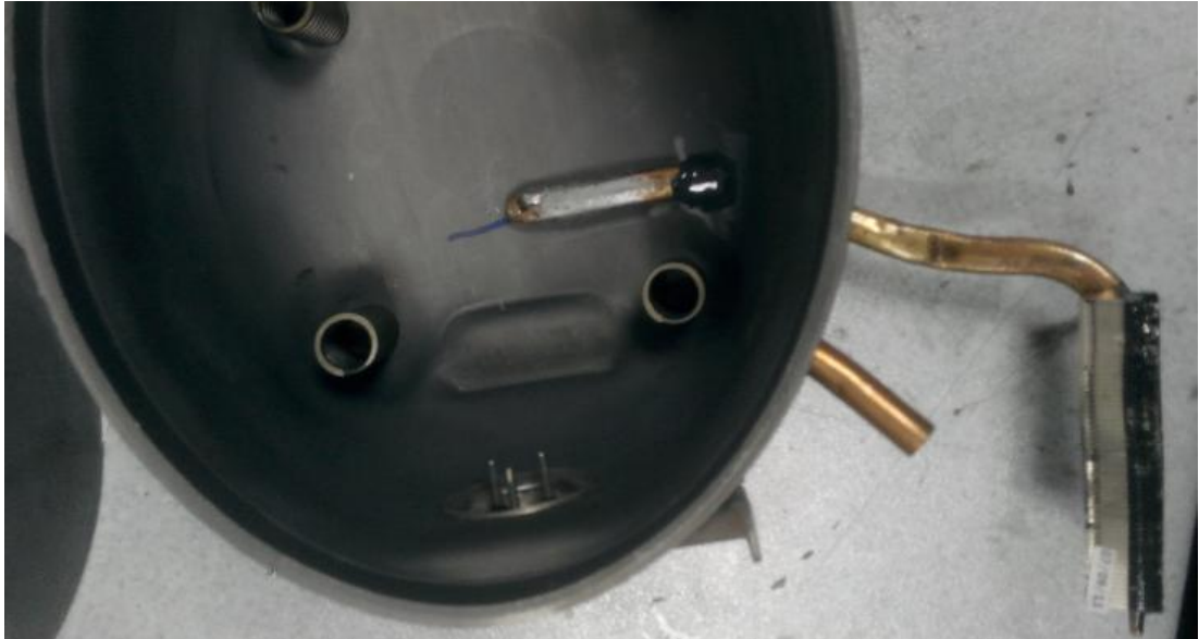
Şekil 3.31: Yağdan dış ortama ısı taşıyan ısı borusu.
