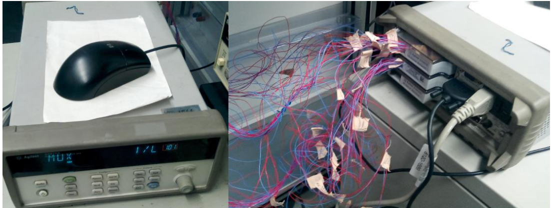
Şekil 3.17: Detay sıcaklık çalışmalarında kullanılan veri toplayıcı ve kart yerleşimi
