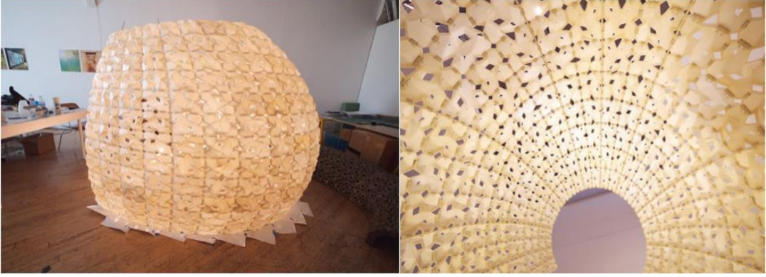
Şekil 17. Emerging Objects Group, SaltyglooPavillion, üç boyutlu yazıcı ve tuz kullanımı ile üretilmiş kabuk (URL- 7)
