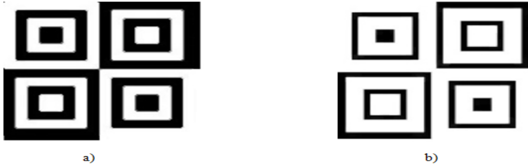
Şekil 3.12. Aşınma İşlemi a) Orijinal Görüntü, b) Aşınma İşlemi Uygulanmış Görüntü
