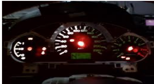
Şekil 1.20 LED kullanılan gösterge panelleri
