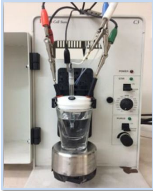
Şekil 3.8. Elektrokimyasal testlerin gerçekleştirildiği üç elektrotlu hücre ve hücre standı
