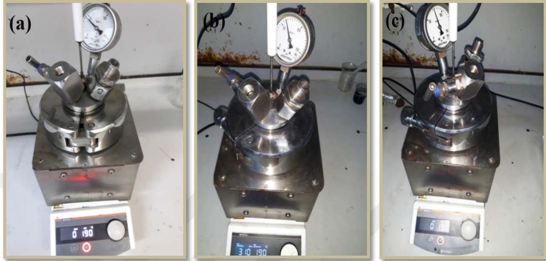
Şekil 3.4. (a) N-GN 24 sa., (b) N-GN 48 sa. ve (c) N-GN 72 sa. için reaksiyon süresinin sona ermesi ile 190 °C’de reaktör basınç değerleri
