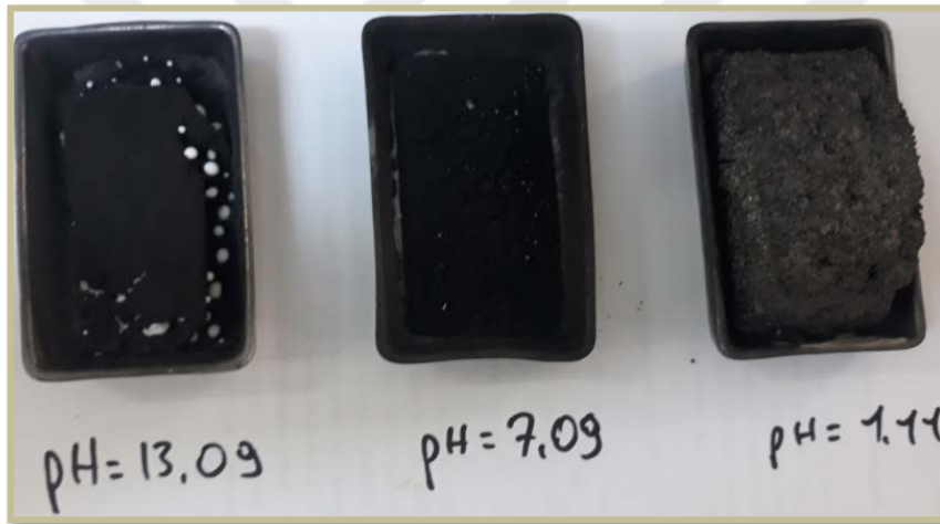
Şekil 3.7. N-GN pH 1, N-GN pH 7 ve N-GN pH 13 örneklerinin piroliz sonrası görselleri
