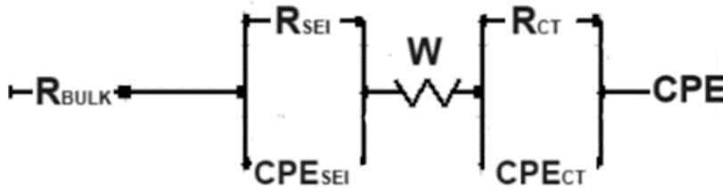
Şekil 4. 42. Tüm örneklerin EIS spektrumlarından elde edilen verileri uydurmak için kullanılan eşdeğer devre modeli.
