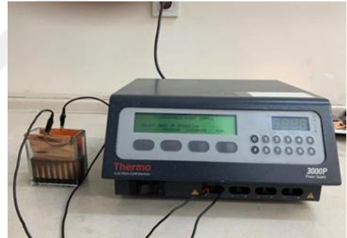
Şekil 3.2. EPD yöntemi ile anot elektrotların hazırlanması için kullanılan düzeneğin şematik gösterimi ve resmi
