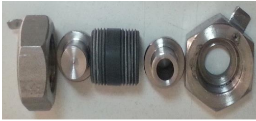
Şekil 3.2. Heteroatom katkılanmış grafenlerin Li-hava pil performanslarının belirlendiği Swagelok tipi iki elektrotlu hücre
