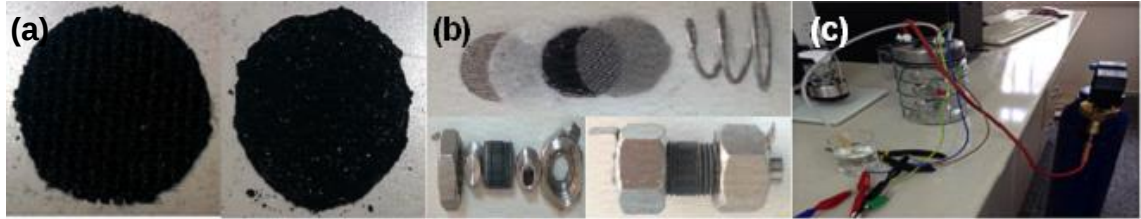
Şekil 4.18. Dairesel şekilde kesilmiş karbon kumaş ve heteroatom kaplanmış karbon kumaş (a) Li-hava pilinde soldan sağa doğru, anot, seperatör, katot, paslanmaz çelik akım toplayıcı ve yay'ın dizilimi ve Swagelok tipi hücre bileşenleri (b) 1,0 atm basınçlı saf \text{O}_2 ortamı sağlayan cam kabin ve test düzeneğinin gösterimi (c)
