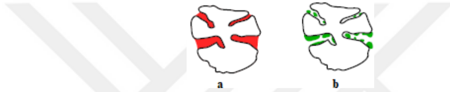
Görsel 4. 2. Islak emdirme sırasında gözeneklerde aktif faz birikimi (a) ve sonrasında uygulanan kurutma işleminin etkisi (b) (Ross, 2012)
