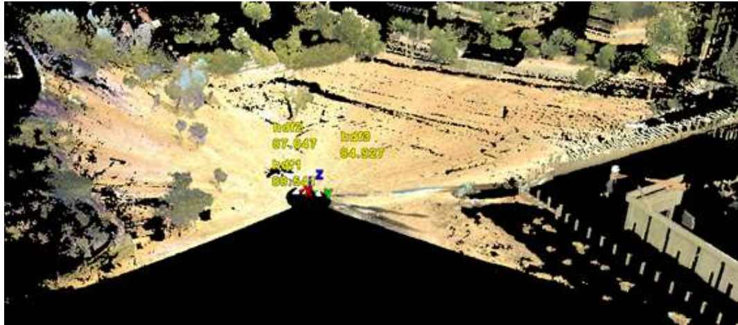
Şekil 4.6 Tez çalışmasındaki heyelan alanı 1. Ölçüme ait örnek nokta bulutu görüntüsü
