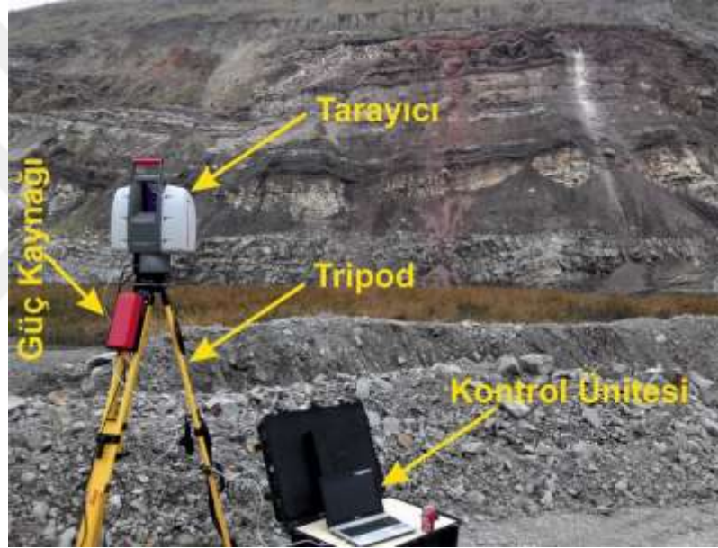
Şekil 3.15 TLS sistemlerinin donanımları (Özdoğan, 2015)
