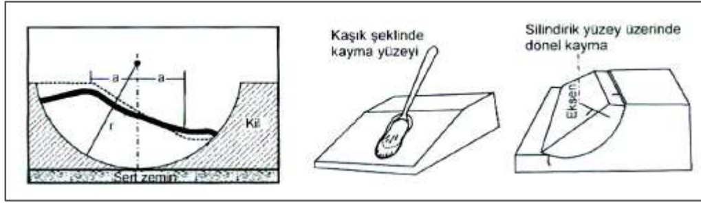
Şekil 2.6 Dönel kayma hareketi (Ünsal, 2010)
