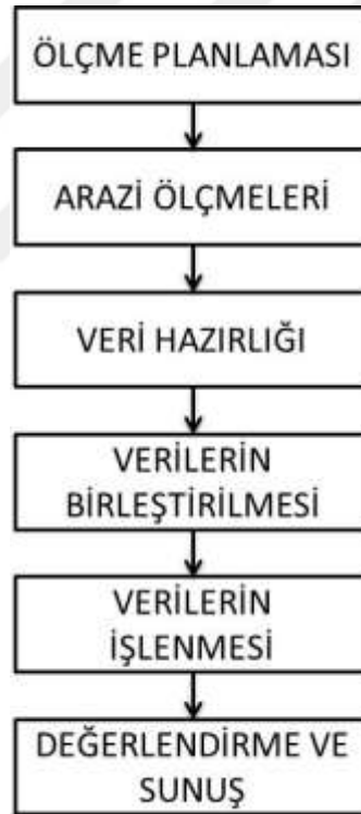
Şekil 4.5 Heyelanların TLS teknikleri ile izlenmesinde kullanılan işlem adımları
