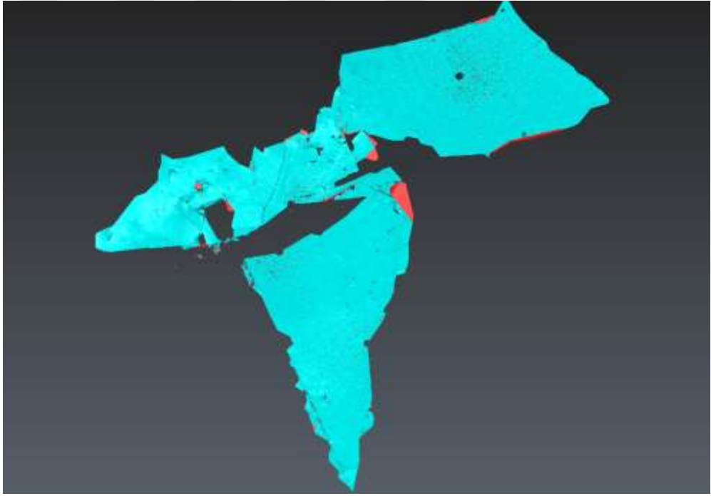
Şekil 4.15 Tez çalışması Balçova alt bölgesine ait ikinci LiDAR ölçümlerinden elde edilen nokta bulutlarından elde edilmiş yüzey (mesh) model
