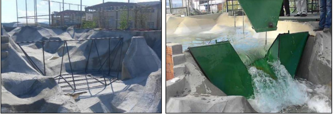
Şekil 13. Baraj yıkılma senaryosu oluşacak dalgaların etkilerinin araştırılması (3 boyutlu topografik modelin oluşturulması ve barajın yenilmesi) (Tayfur and Güney 2013).
