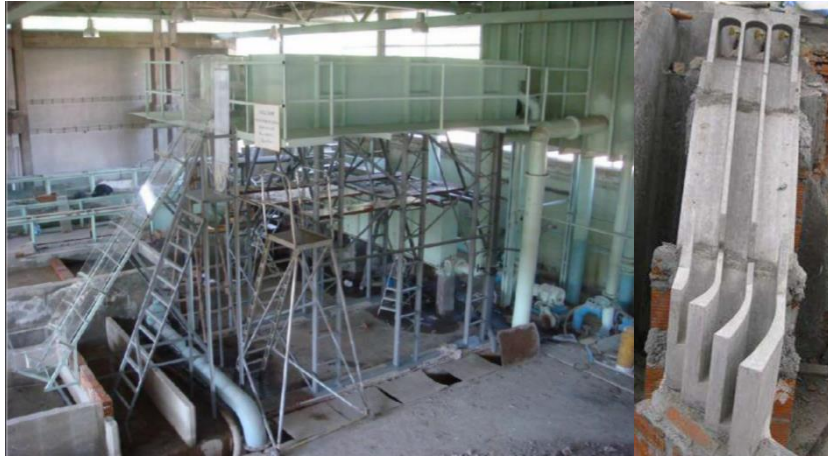
Şekil 10. Taşkın dalgalarının mühendislik yapıları üzerindeki etkilerinin belirlenmesi için hazırlanan fiziksel prototip modeller (Usta 2014, Ninot et al. 2015)
