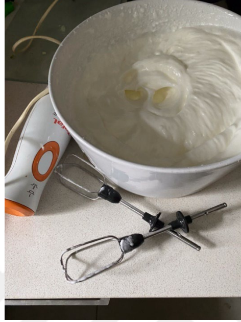
Görsel 49. Albümin çözeltisi hazırlığı için mikser ile yumurta akı, amonyum klorür, damıtılmış su ve asetik asit içeriklerinin karıştırılması süreci.
