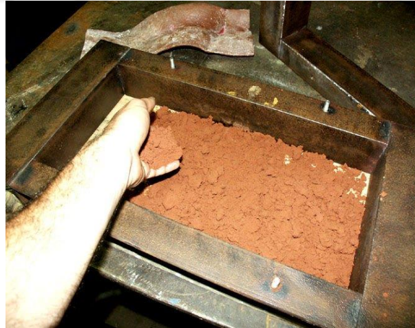
Görsel 2.4. Kalıp Kasasına Kum Ekleme Aşaması
