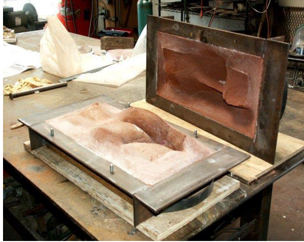
Görsel 2.12. Kalıbın Açılma Aşaması ( https://www.instructables.com/id/Making-a-sand-cast-bronze-sculpture/#discuss , Erişim tarihi: 17.02.2019)
