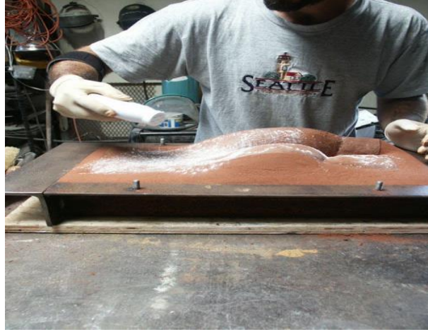
Görsel 2.7. Ayrıştırıcı Pudra Uygulanması Aşaması ( https://www.instructables.com/id/Making-a-sand-cast-bronze-sculpture/#discuss , Erişim tarihi: 13.02.2019)
