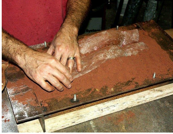
Görsel 2.5. Mum Modelin Kuma Yerleştirilme Aşaması ( https://www.instructables.com/id/Making-a-sand-cast-bronze-sculpture/#discuss , Erişim tarihi: 13.02.2019)
