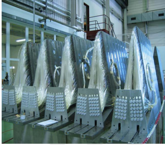
Şekil 2.19 HF kulelerine yerleştirilen kuartz fiberlerinin görseli
