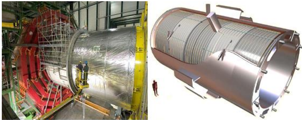
Şekil 2.8 CMS deneyinin süperiletken mıknatısı [23]
