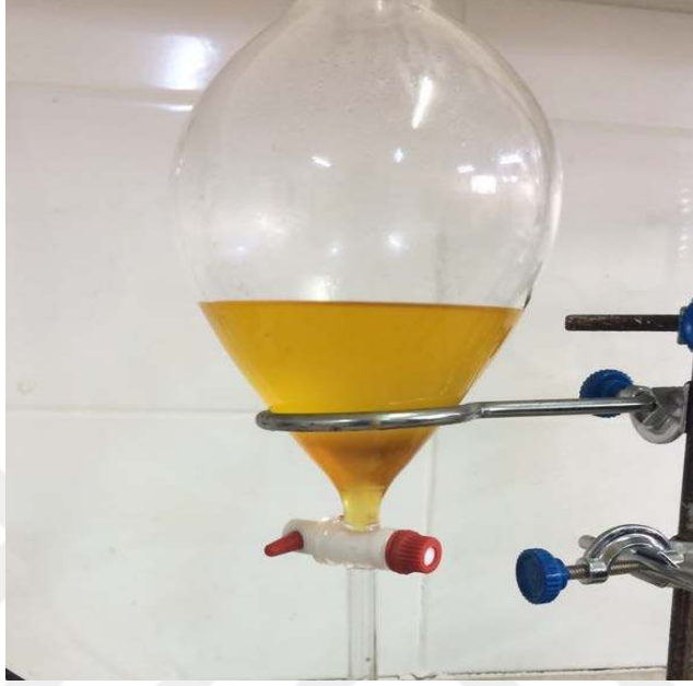
Fotoğraf 4.4. Transesterifikasyon Reaksiyonu Sonunda Faz Ayrılması
