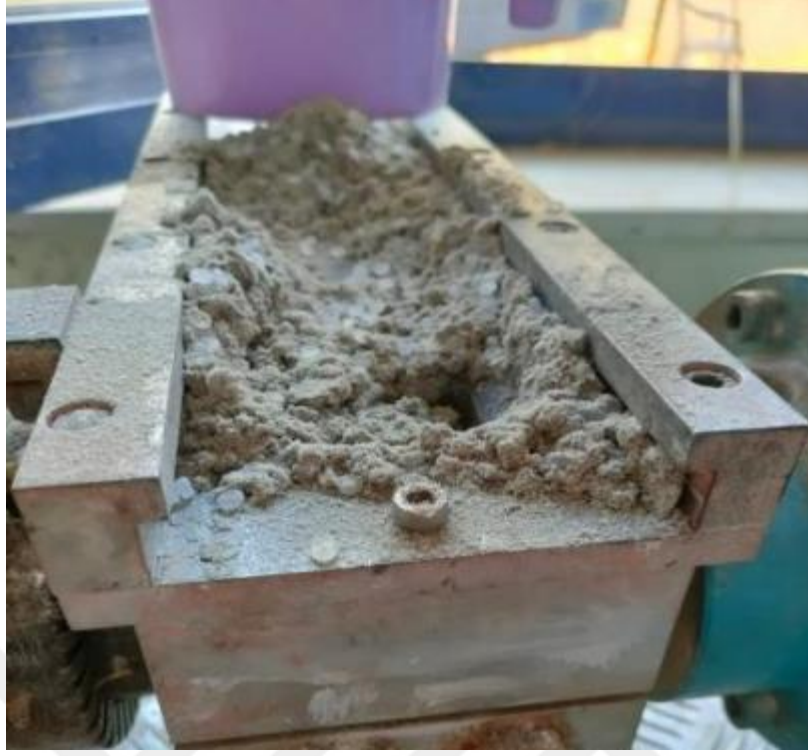
Şekil 15. Karışımın besleme ağzından ekstrudera dökülmesi.
