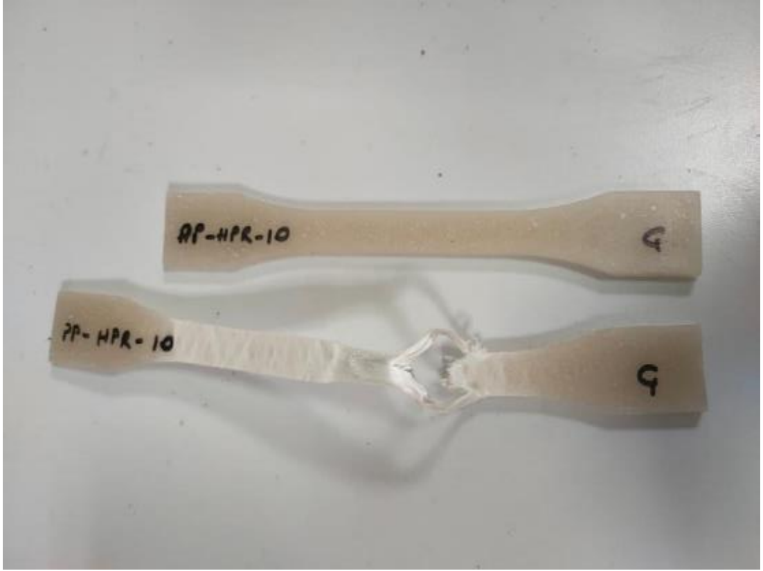
Şekil 22. Çekme direnci testi deney öncesi ve sonrası görüntüsü
