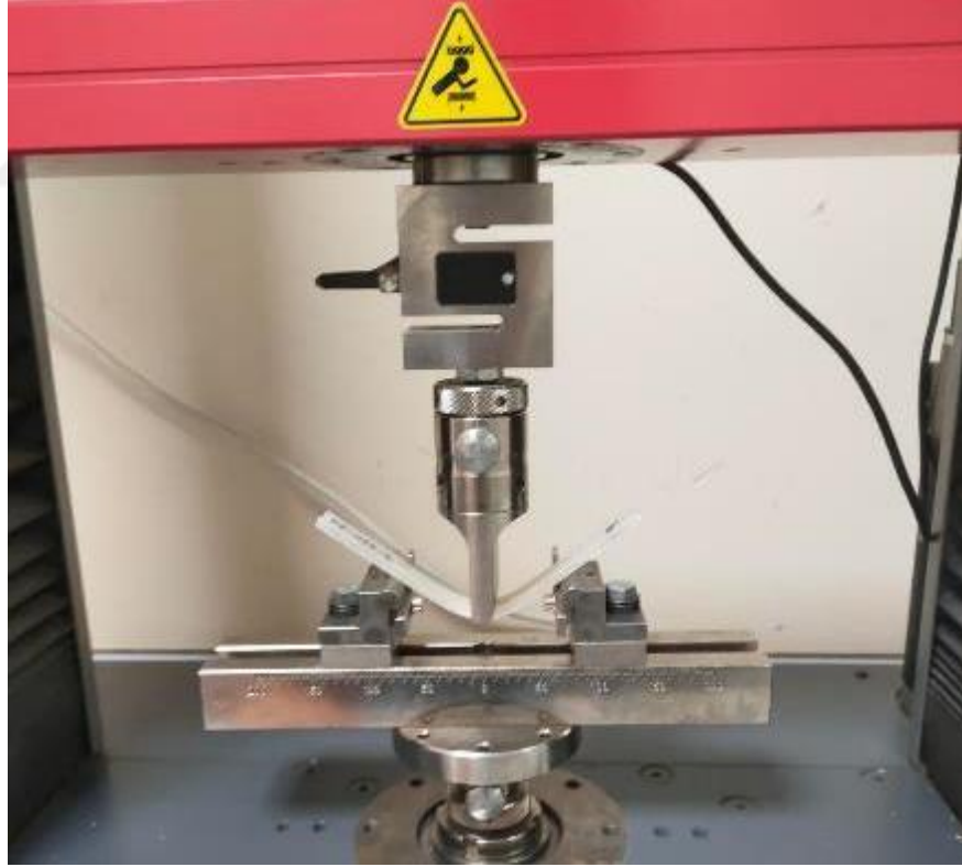
Şekil 20. Eğilme direnci testi deney aşaması
