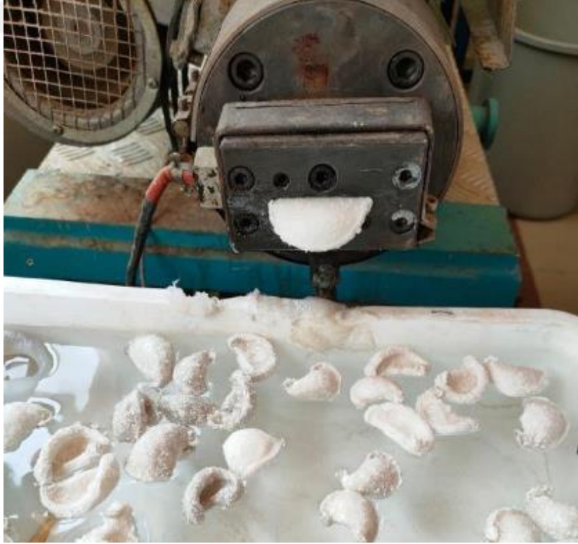
Şekil 16. Ekstruderden erişim haldeki karışımın çıkışı
