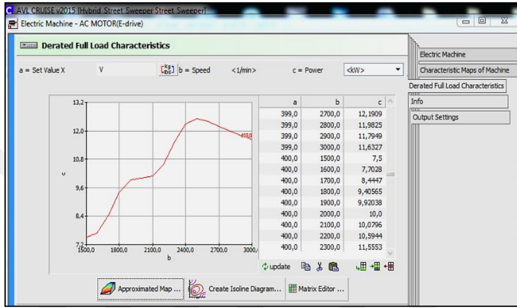
Şekil 5.6. Seri hibrit mod için AC motor voltaj, devir sayısı ve güç
