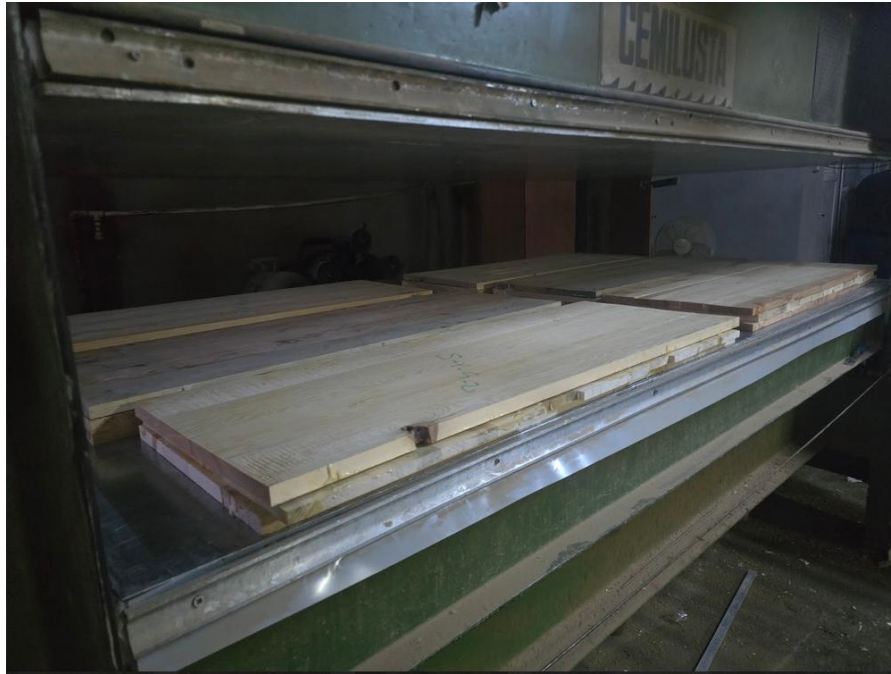
Şekil 3.3: 54 x 400 x 1100 mm ÇLK'ların preslenmesi.
