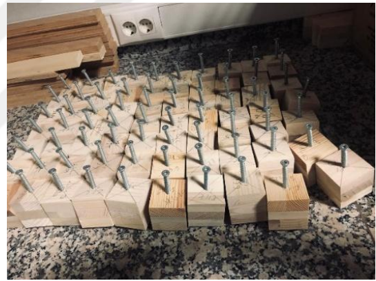
Şekil 3.8: a. 6 × 70 mm vida çekme örneği, b. Vida çekme test düzeneği, c. 7 × 100 mm vidalama ile hazırlanan örnekler ve d. 7 × 100 mm vida ile 3 katman penetre vidalama örnekleri.
