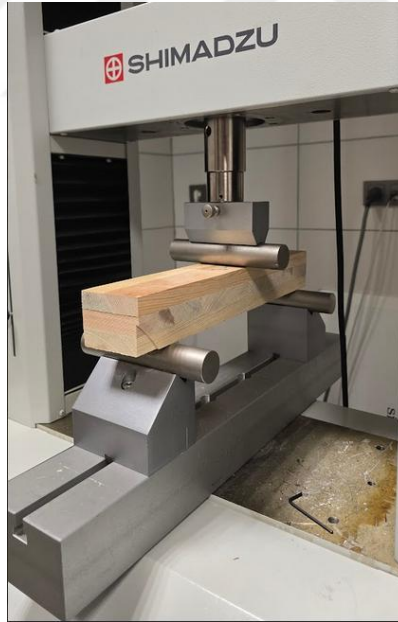
Şekil 3.5: Kayma modülü tayini için deney düzeneği.
