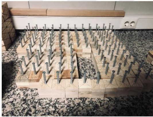
Şekil 3.8: a. 6 × 70 mm vida çekme örneği, b. Vida çekme test düzeneği, c. 7 × 100 mm vidalama ile hazırlanan örnekler ve d. 7 × 100 mm vida ile 3 katman penetre vidalama örnekleri.
