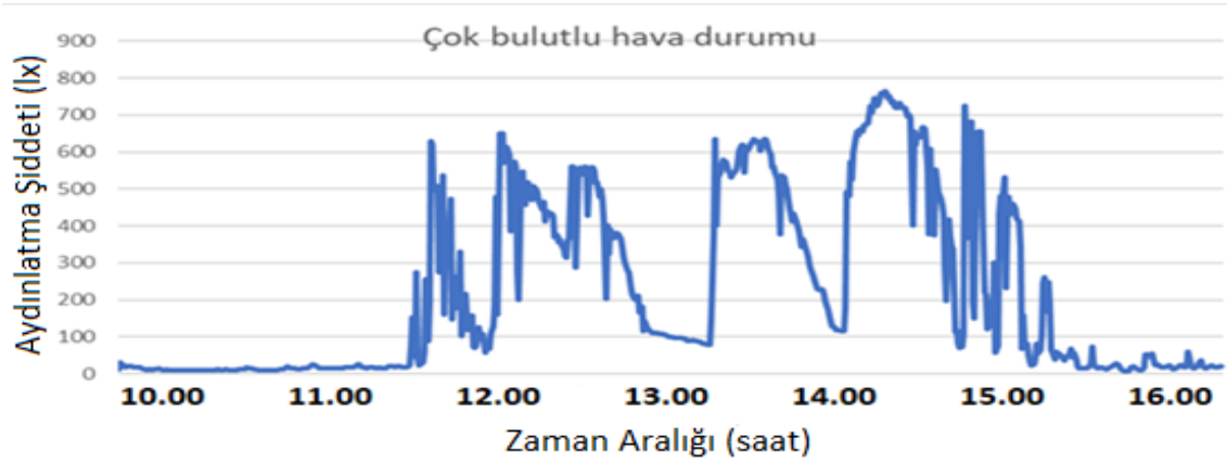
Şekil 4.2 Çok bulutlu ve ara ara güneşli hava şartlarında sistemden elde edilen aydınlatma şiddeti değişim grafiği (20.03.23).
