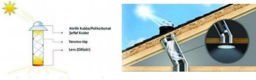
Şekil 2.9 Işık tüpü sistemlerinin iç yapısı ve çalışma şekli (İnt. Kyn. 13).
