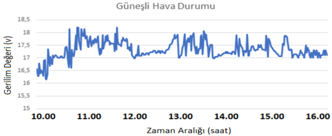
Şekil 4.12 Güneşli hava durumu panellerden üretilen gerilim değerleri.
