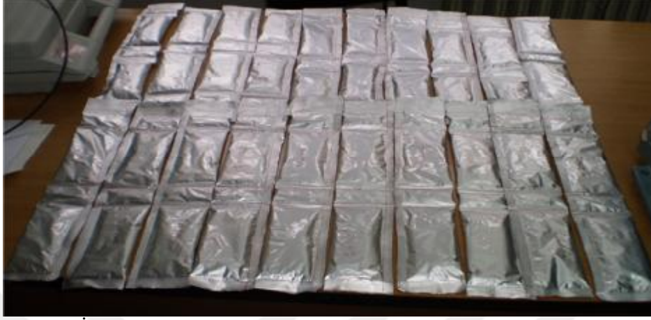
Şekil 3.19. İki farklı FDM için hazırlanan 20 adet FDM paketi
