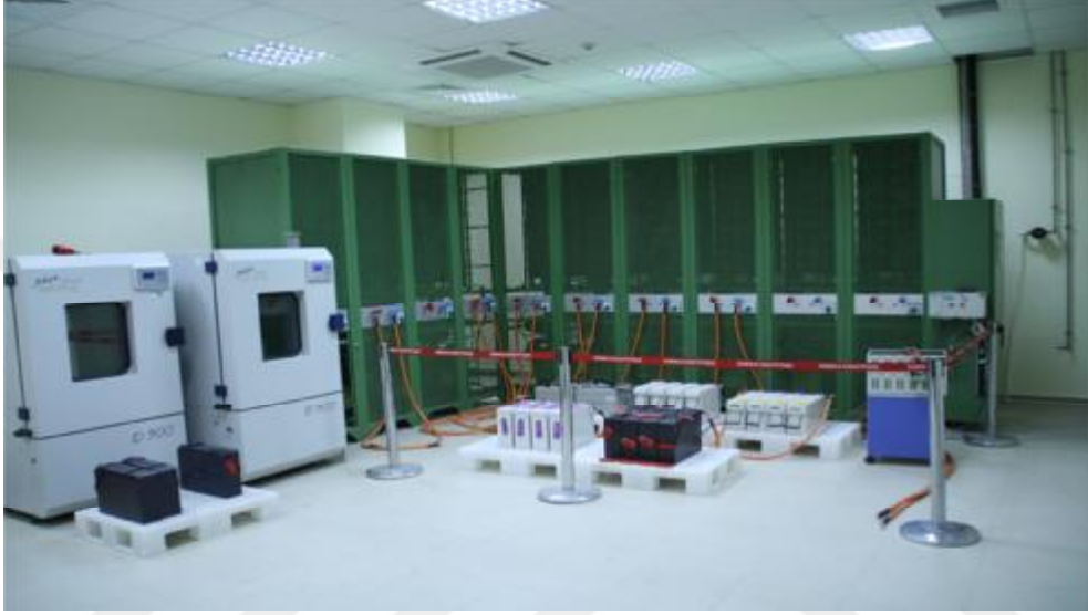
Şekil 3.8. Batarya test sistemi (72V, 200 A)
