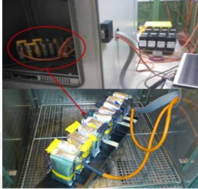
Şekil 4.61. Sıcaklık ölçümlerinin alındığı iklim kabini ve batarya modülü
