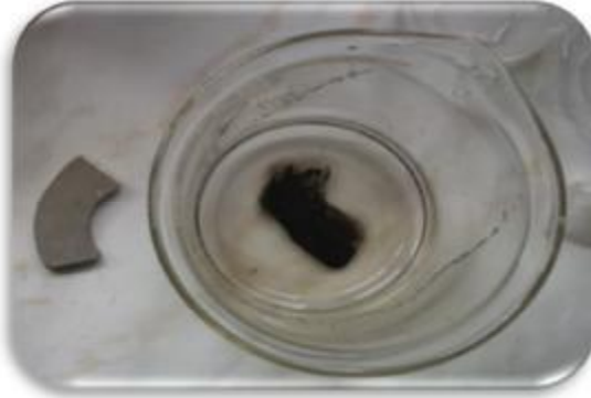
Şekil 3.11. Sentezlenen magnetit demir nano partiküllerin mıknatıs ile çöktürülmesi (Şahan,2011)
