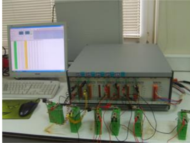
Şekil 3.7. Batarya test sistemi (5V, 3 A)
