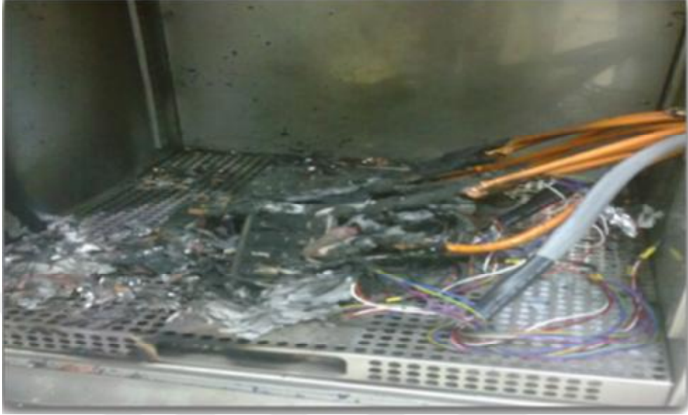
Şekil 4.57. Patlama sonrasında batarya bloğu ve sıcaklık okuyucularının görüntüsü
