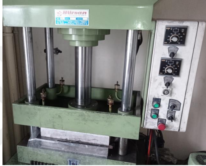
Resim3.6 Kompozit üretiminde kullanılan sıcak pres.
