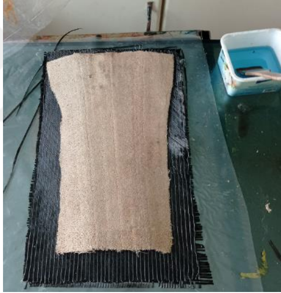
Resim 3.5 Karbon ve kabak elyaflarının masa üzerinde sırasıyla reçine emdirilerek birleştirilme işlemi.
