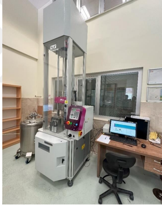
Resim 3.9 Instron / ceast 9350 düşük hız darbe test cihazı.
