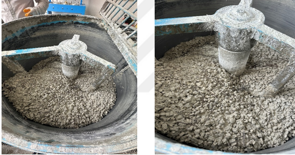
(a) Lifsiz ve çelik lifli betonun hazırlanması
