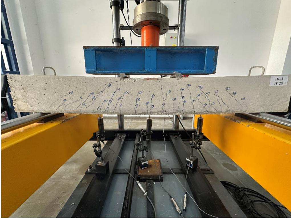
(b) HB-I-4F-2S kirişinin kırıldıktan sonraki görünümü
