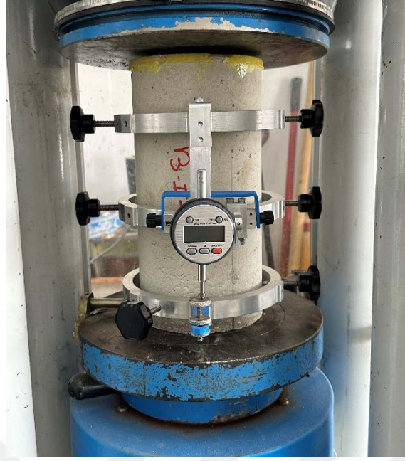
Şekil 3.5 Silindir numunelere basınç deneyi uygulanması
