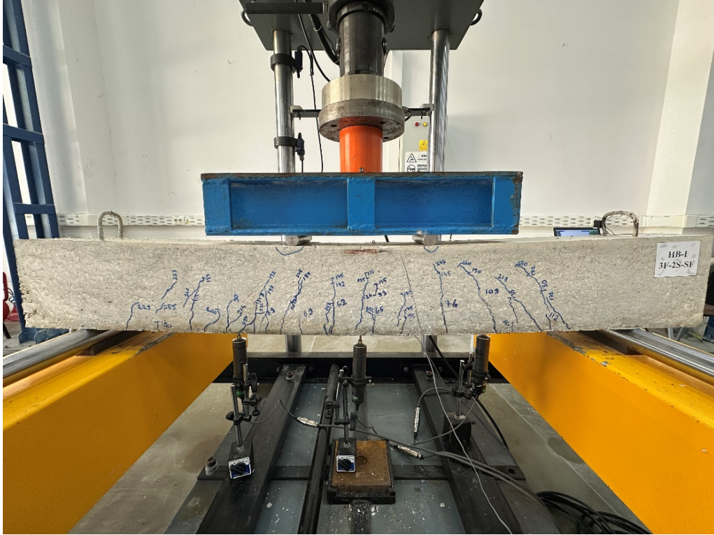
(b) HB-I-3F-2S-SF kirişinin kırıldıktan sonraki görünümü
