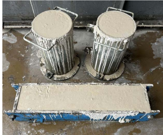
(a) Lifsiz ve çelik lifli betonun hazırlanması
