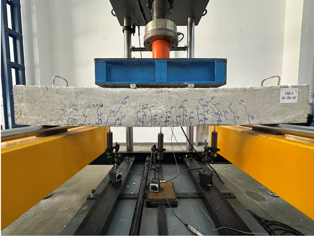
(b) HB-I-4F-2S-SF kirişinin kırıldıktan sonraki görünümü
