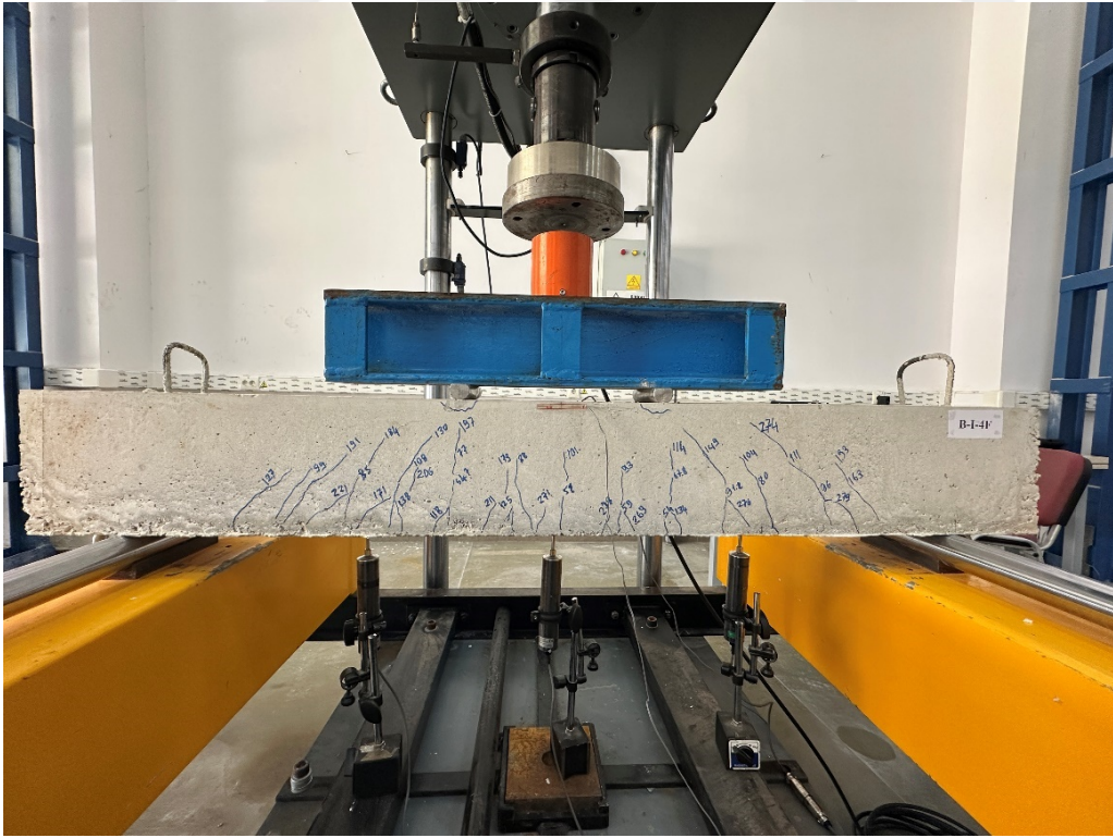
(b) B-I-4F kirişinin kırıldıktan sonraki görünümü
