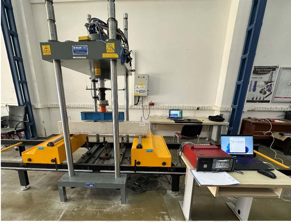
(a) B-I-4F kirişinin kırılmadan önceki görünümü
