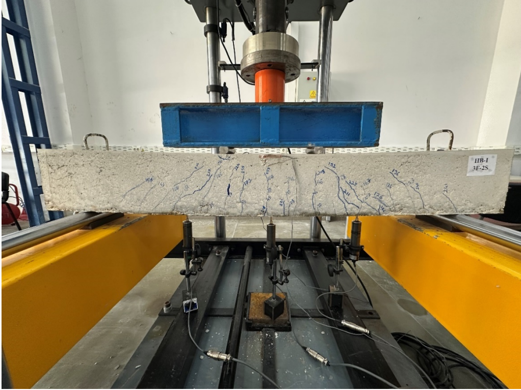
(b) HB-I-3F-2S kirişinin kırıldıktan sonraki görünümü
