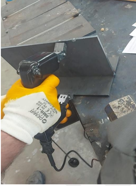
Görsel 2. 10. Şekil a ve Şekil b de manyetik alan ilşemi gösterilmiştir.
