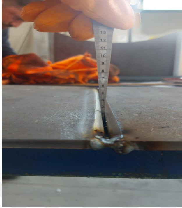
Görsel 2. 6. Açılan kaynak ağzının derinliğine bakıldı.
