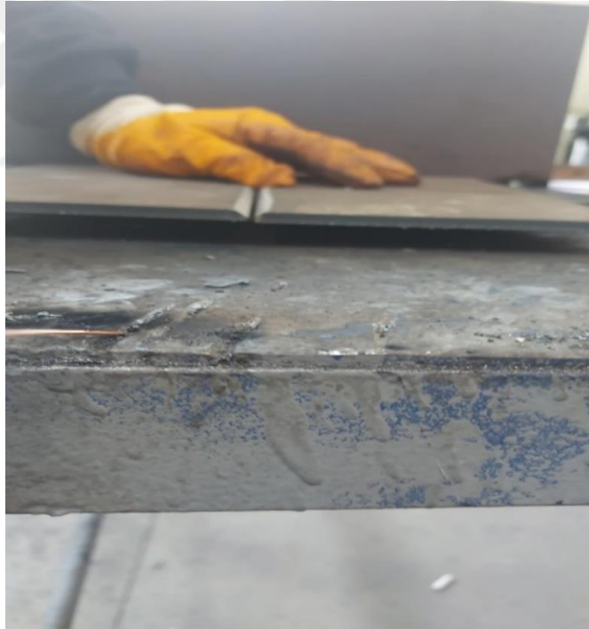
Görsel 2. 7. Karşılıklı Kaynak ağzı açılmış protac500
