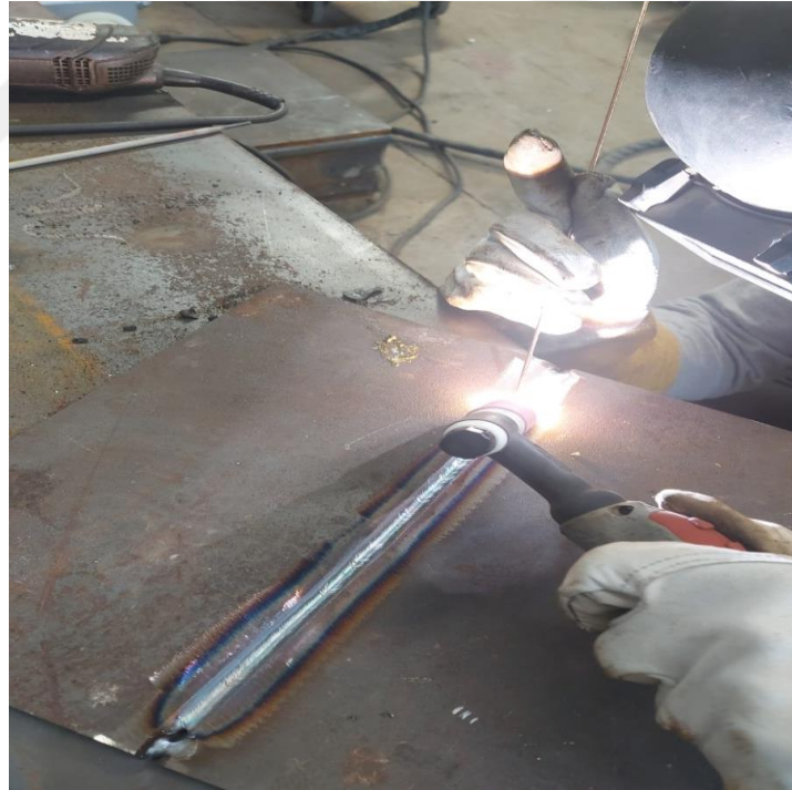
Görsel 2. 18. ER309L Kaynak Çubuğunun Argon kaynak yöntemiyle kaynak edilmesi
