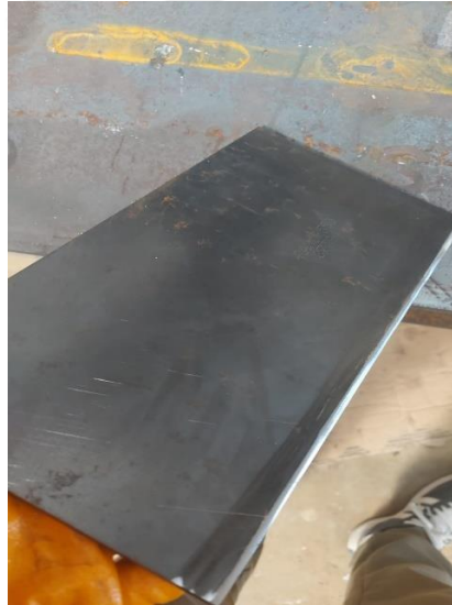
Görsel 2. 5. 40 ile 45 derece arasında kaynak ağzı açılmış Protac 500
