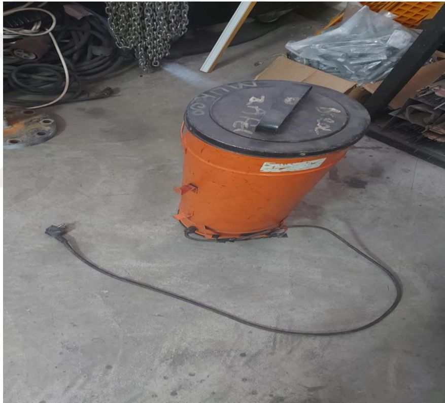
Görsel 2. 8. Elektrot kaynağında kullanılan elektrotun Termoseslenme işlemi
