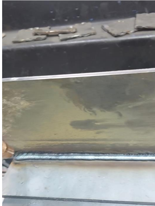
Görsel 2. 20. T kaynak yöntemiyle yapılan GMAW135(Automatic) Protac 500
