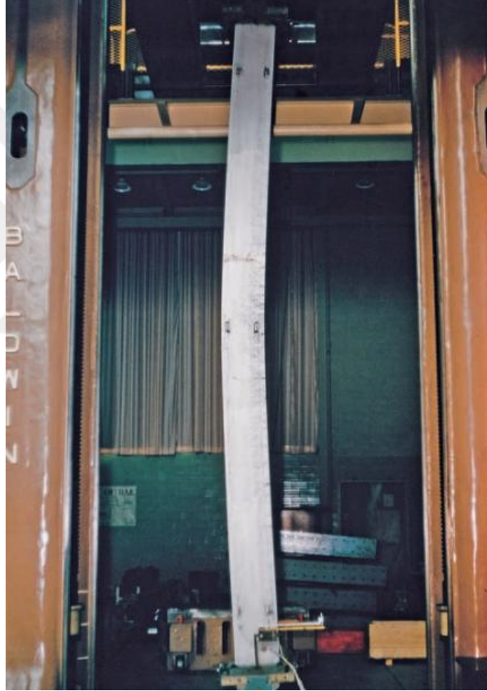
Şekil 3. 1 : Deneysel olarak gözlemlenen yapısal burkulma olayı [76].
