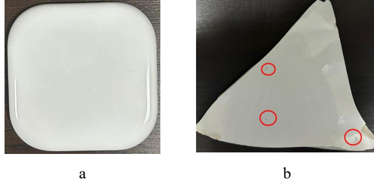
Şekil 7.1 Seramik Yüzeyler a) Referans Yüzey b) Hava Kusuru Bulunan Kusurlu Yüzey.
