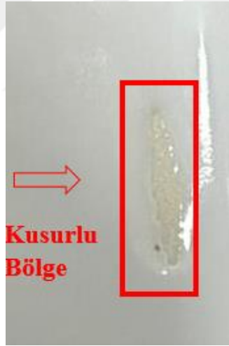
Şekil 7.26 Toplama Kusuru Bulunan Yüzeye Ait Seramik Görseli.
