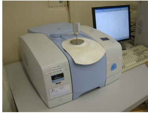
Şekil 2.13. FT-IR Spektroskopisinin şematik gösterimi
