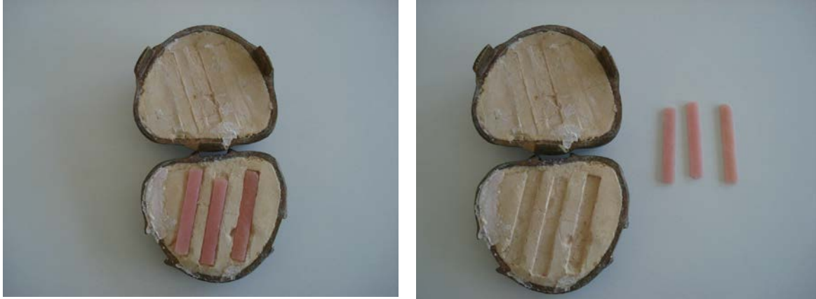
Şekil 3. 6. Mufla kalıplarında test örneklerinin hazırlanması
