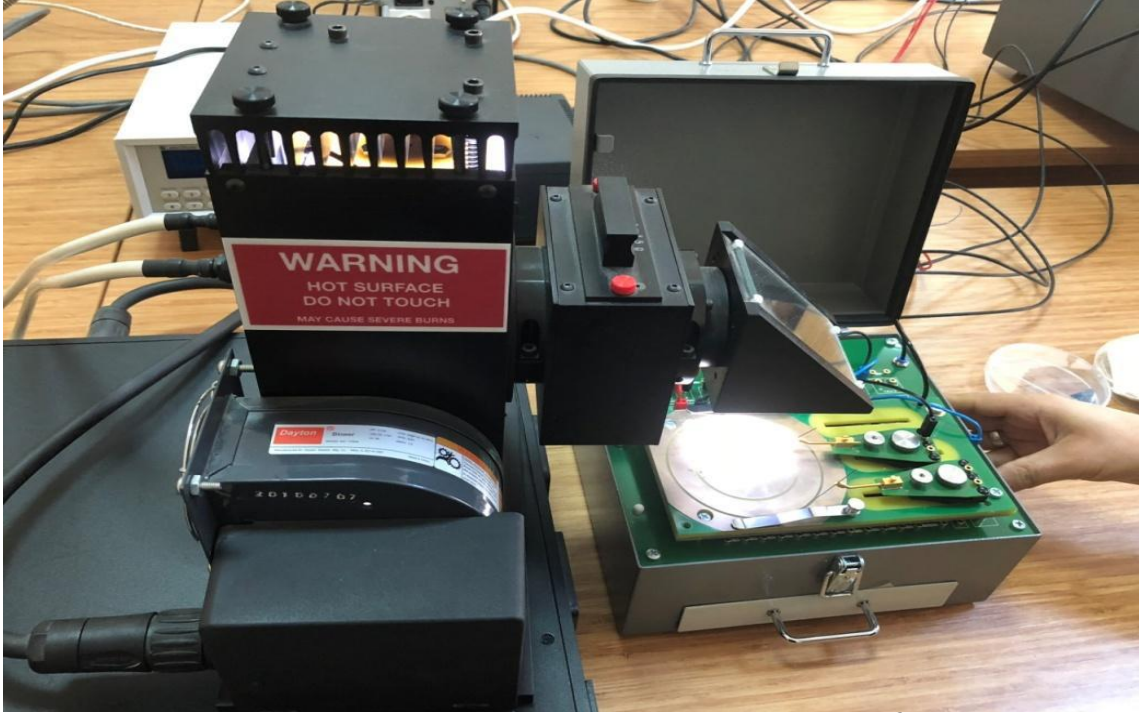
Şekil 3.6 . Organik ara yüzeyli Al/PTCDI-C8/p-Si/Al diyotunun 100 \text{ mW/cm}^2 gücünde ve oda sıcaklığında solar simülatör cihazı ile ölçüm düzeneği
