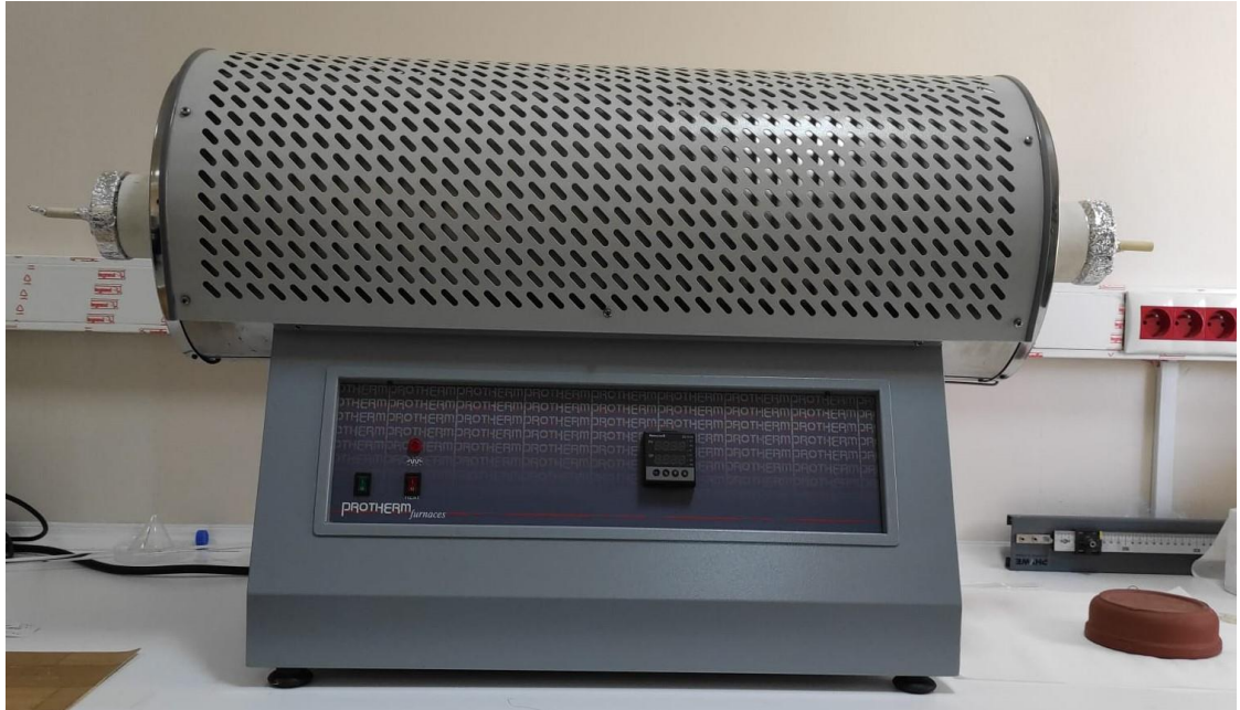
Şekil 3.3. Tavlama için kullanılan tüp fırının fotoğrafı
