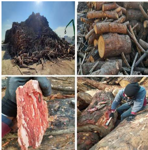
Şekil 3.1 : Kızılçam tomruklarından kabuk elde edilmesi.
