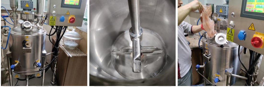
Şekil 3.4 : Tanen ekstraksiyon işlemi.
