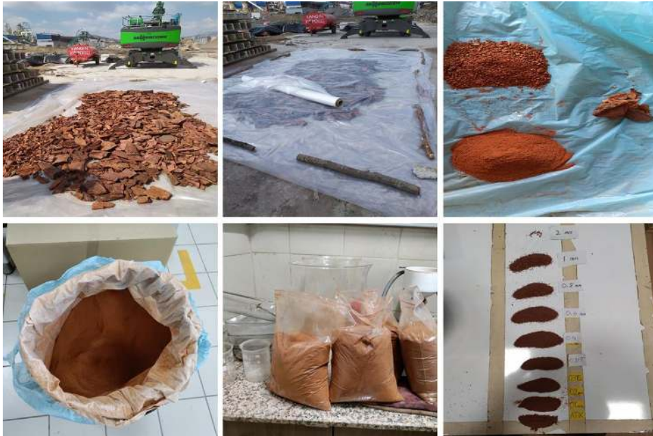
Şekil 3.3 : Kabukların hava kurusu ve toz hale getirilmiş hali.
