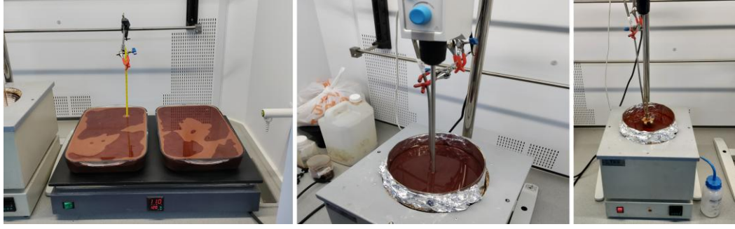
Şekil 3.5 : Ekstraksiyon sonrası çıkan süzütünün buharlaştırılması.
