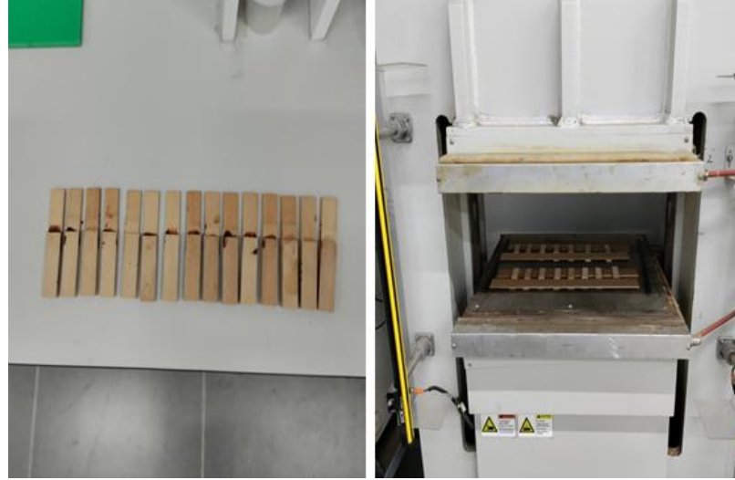
Şekil 3.18 : Lap shear örneklerinin preslenmesi.
