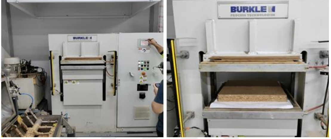
Şekil 3.24 : Burkle lab tipi sıcak pres.
