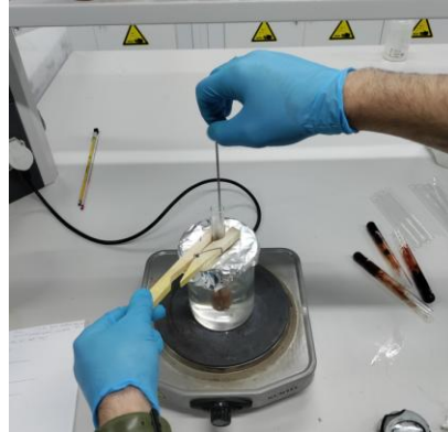
Şekil 3.14 : Jel süresi testi.
