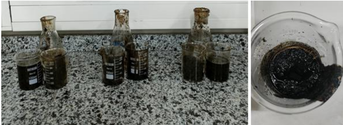
Şekil 4.3 : Katran malzemesinin farklı oranlarda aseton ile çözünme çalışmaları.
