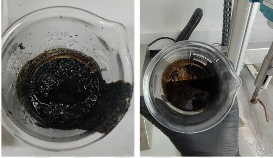
Şekil 3.10 : Farklı çözücüler ile katranın çözülmeye çalışılması.
