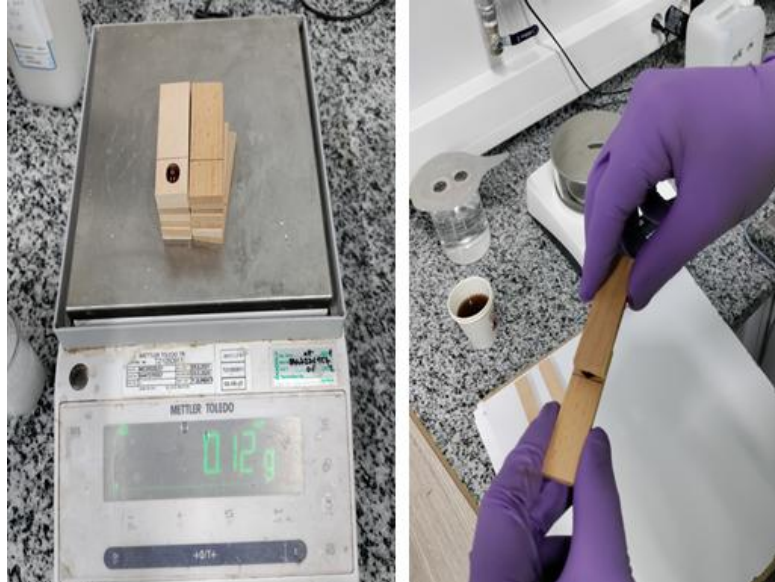
Şekil 3.17 : Lap shear örneklerinin hazırlanması.
