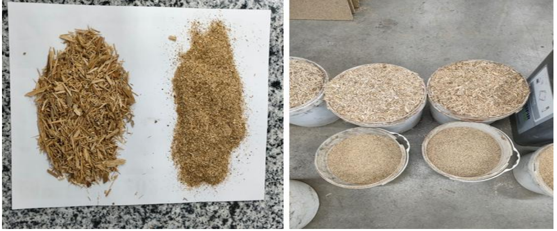
Şekil 3.20 : Dış tabaka ve orta tabaka yongaları.
