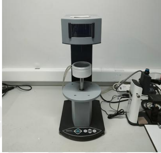
Şekil 3.26 : Yüzey gerilim test cihazı (Biolin Scientific Sigma 702).
