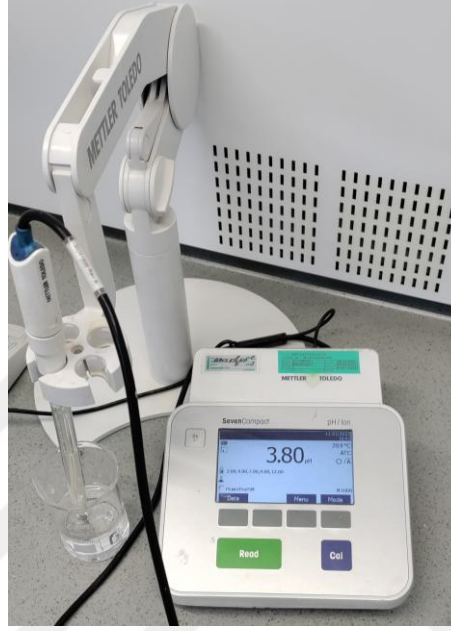
Şekil 3.11 : Mettler Toledo pH metre.
