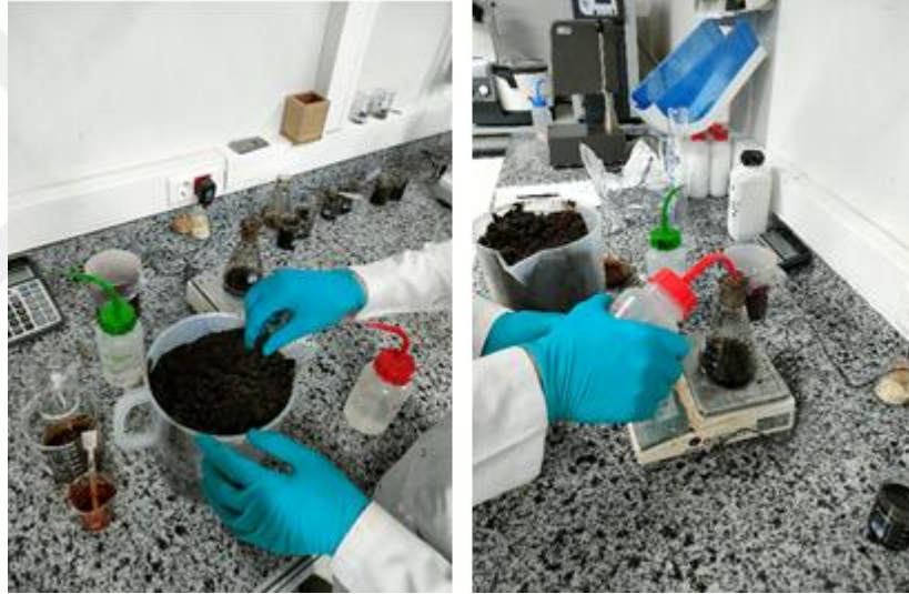
Şekil 3.8 : Katran formülasyonlarının hazırlanması.
