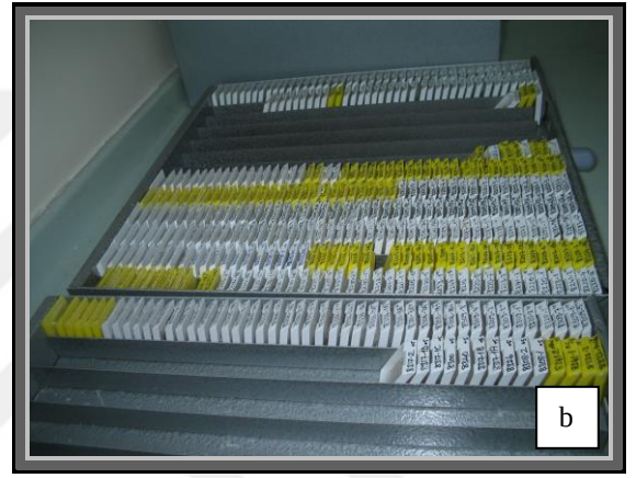
Şekil. 3.13. a,b) Temizlenmiş parafin kalıplarının örnek kabında muhafaza edilmesi
