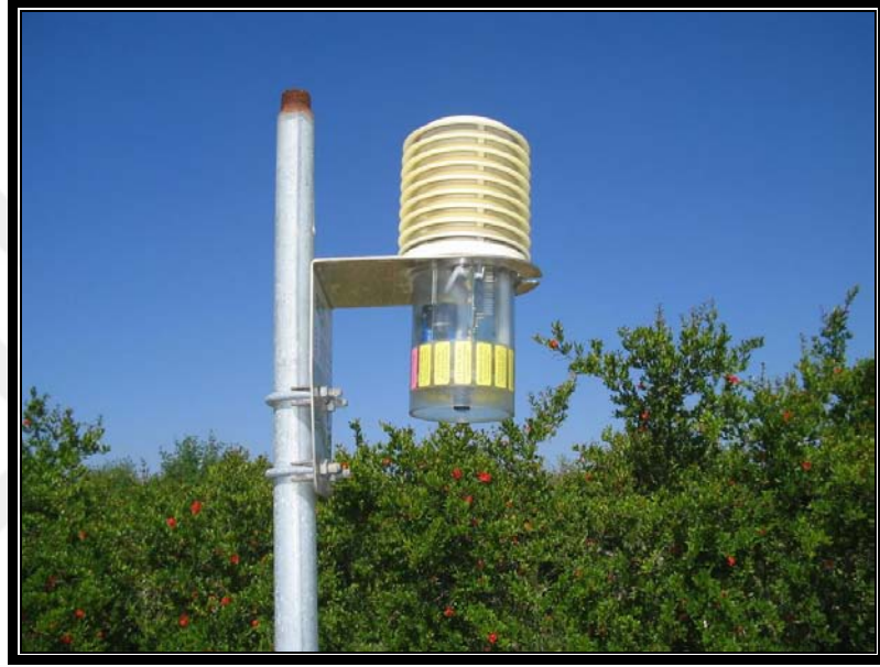
Şekil 3.16. Denemenin yürütüldüğü araziye monte edilerek sıcaklık, nem, ışık ve solar radyasyon miktarları ile güneşlenme sürelerinin ölçüldüğü iklim istasyonu
