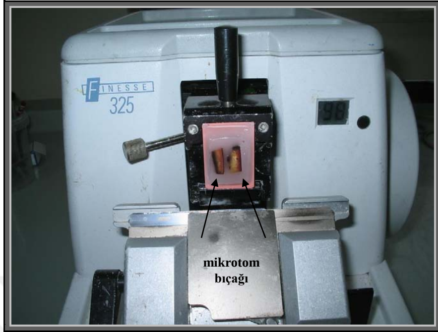
Şekil 3. 14. Mikrotomda örneklerden kesit alınması.
