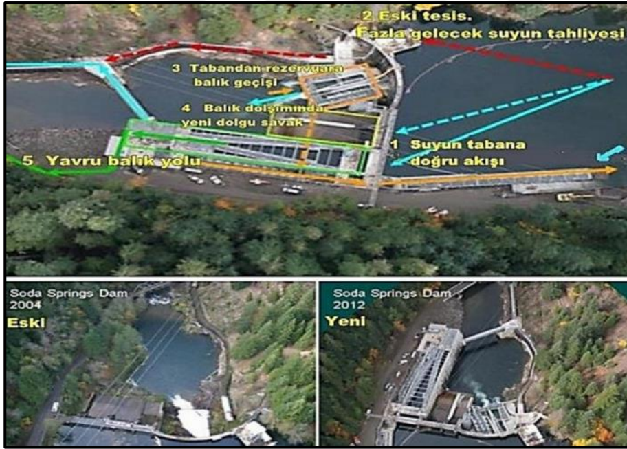
Şekil 1.24. Mevcut baraja sonradan yapılan bir balık geçidi (Bozkurt ve Yüksel, 2017).
