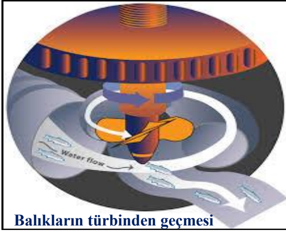
Şekil 1.12. Türbinlerdeki balık geçişleri (URL-8, 2021). Izgaraların balık göçünü engellemesi (Berkün vd., 2008).
