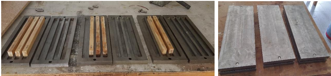
Şekil 3.1. Metal kalıplara yerleştirilmiş örnekler.
