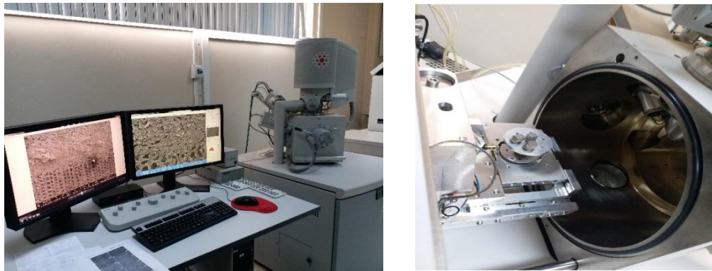
Şekil 3.10. SEM görüntüleme cihazı ve örneklerin cihaza yerleştirilmesi ve ölçümü
