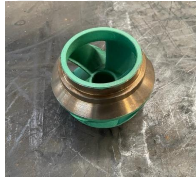
Şekil 3.5. Santrifüj pompa çarkının kaplamasız ve kaplamalı görüntüsü
