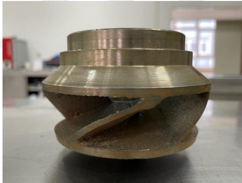
Şekil 3.5. Santrifüj pompa çarkının kaplamasız ve kaplamalı görüntüsü
