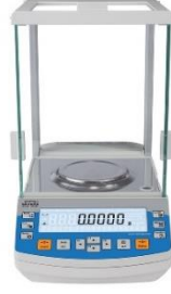
Şekil 3.4. Radwag AS220.R2 tip hassas terazi
