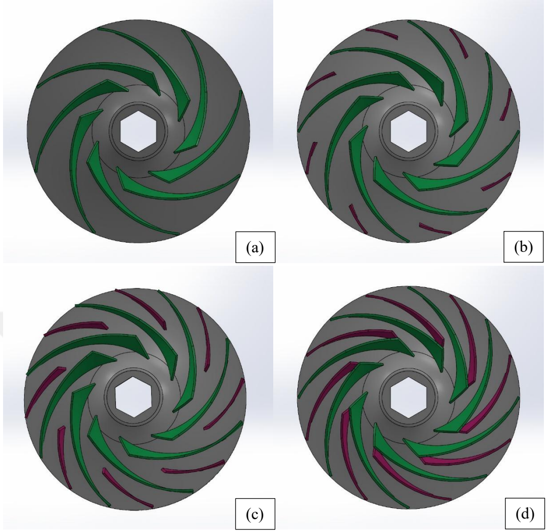
Şekil 3.15. Sekiz ana kanata sahip çarklar (a) Ara kanatsız (Tasarım-13) (b) Ana kanatın %25'i uzunluğunda ara kanatlı (Tasarım-14) (c) Ana kanatın %50'si uzunluğunda ara kanatlı (Tasarım-15) (d) Ana kanatın %75'i uzunluğunda ara kanatlı (Tasarım-16)
