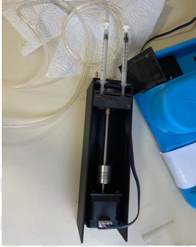
Şekil 3. 2. Biyoyazıcıda çift şırınga denemesi
