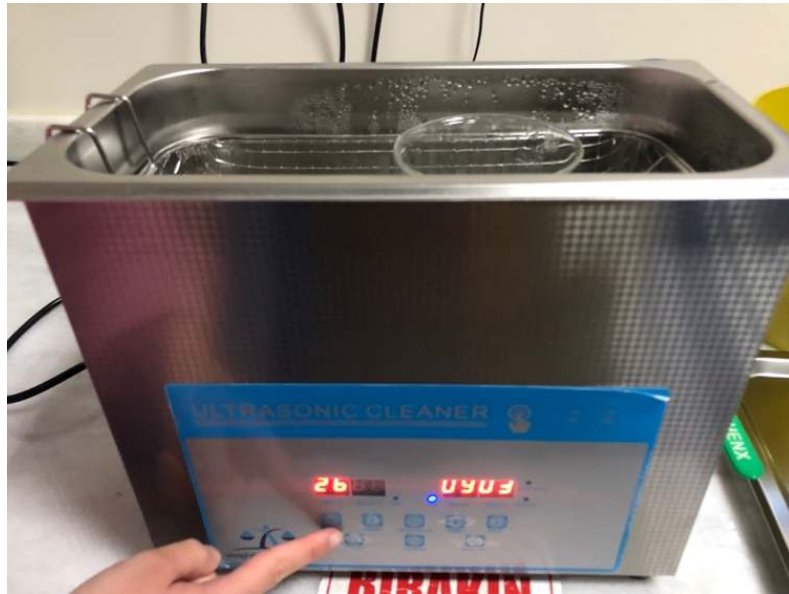
Şekil 4. 7. Çözeltilerin Ultrasonik Temizleyicide Temizlenmesi
