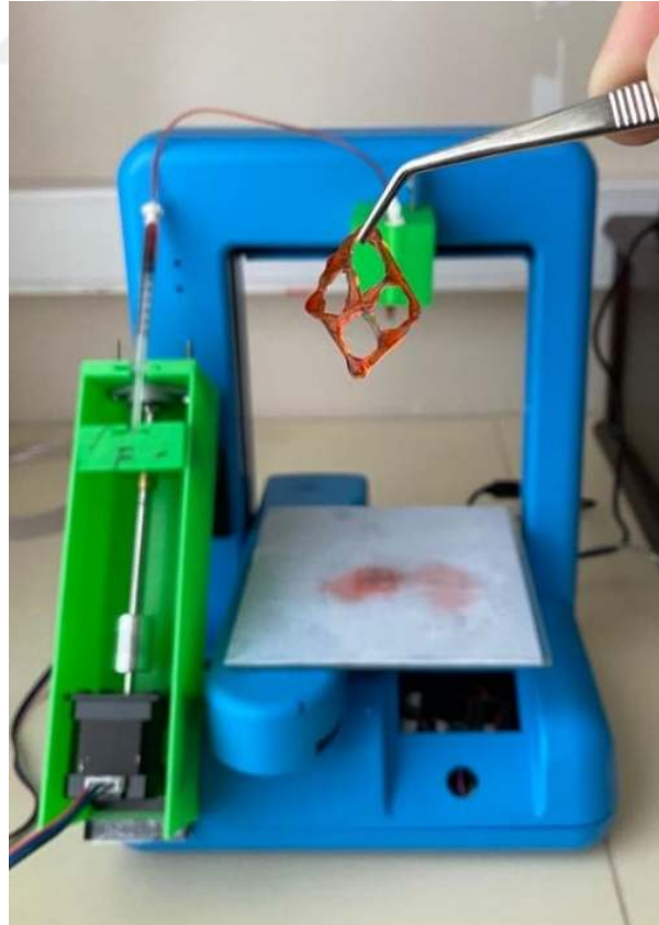
Şekil 4. 10. %3'lük Aljinatın Çaprazlanmış Formu [1]
