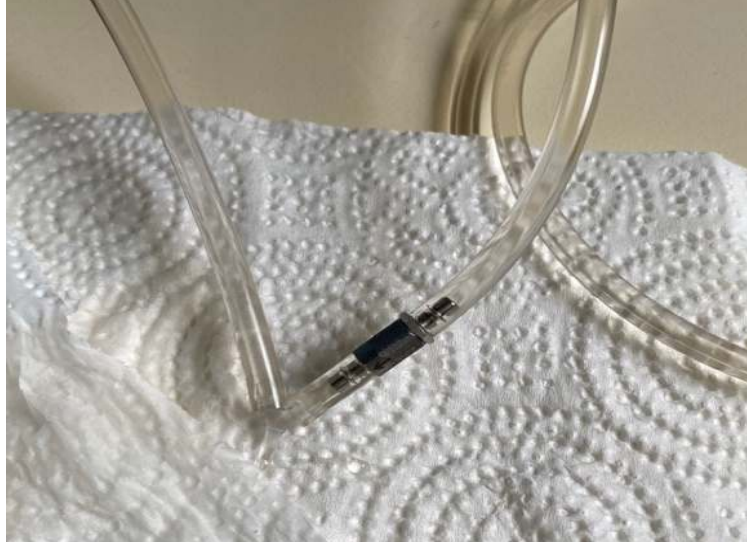
Şekil 3. 3. 2 Çift şırınga modelinde aljinat ile dolu olan hortuma takılan valf
