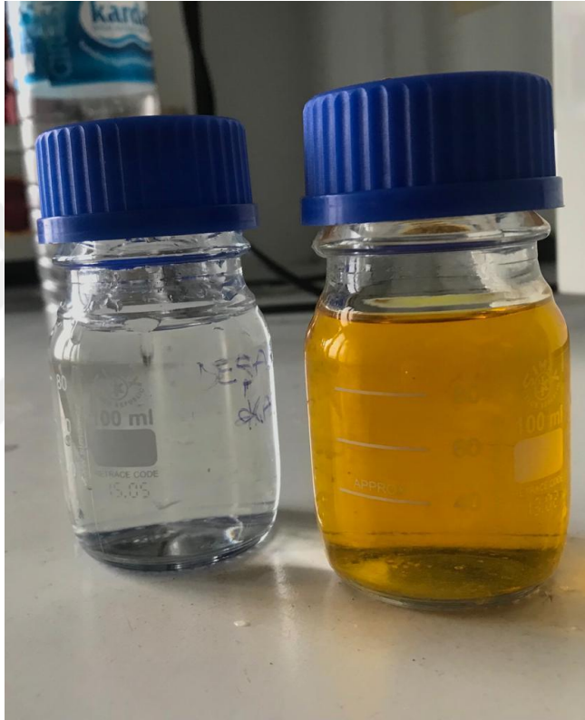
Şekil 4.9. Yüzey modifikasyonuna uğrayan elektrot IrNi/C katalizörü varlığında hidrojen-brom akış pili şarj sırasında gerçekleşen renk değişimi
