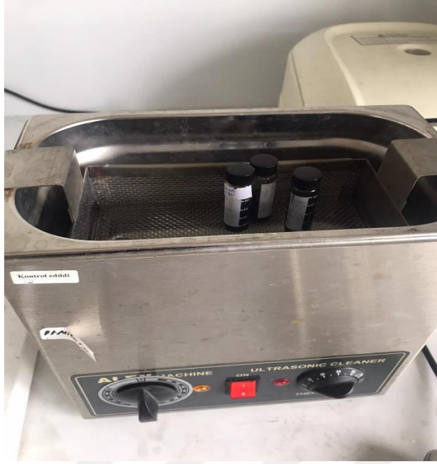
Şekil 3.2. Katalizör mürekkebinin ultrasonik banyoda homojenizasyonu
