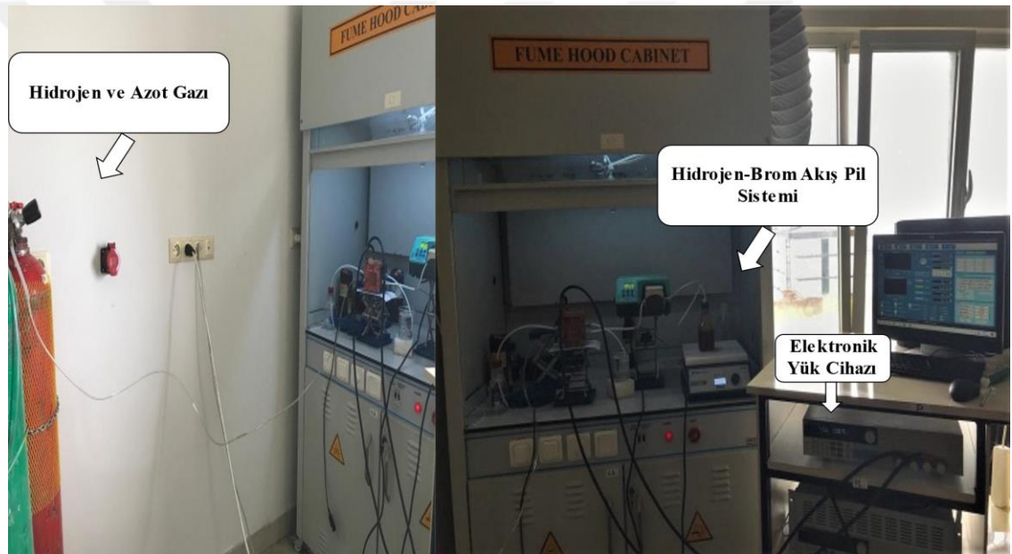
Şekil 3.15. Hidrojen-Brom akış pil deşarj sistemi, elektronik yük ve gazlar
