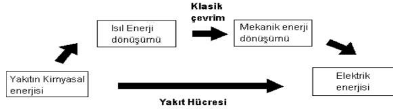
Şekil 1.2. Geleneksel teknoloji ve yakıt pillerinde enerji dönüşümü [219]
