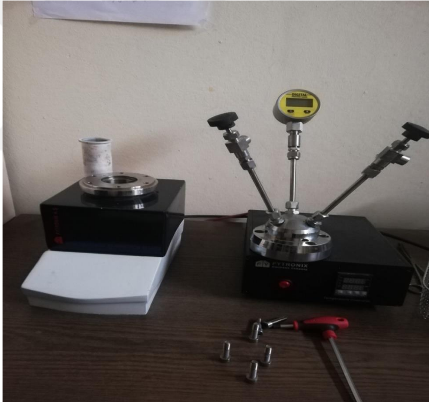
Şekil 3.8. Hidrotermal Kaplama Yöntemi
