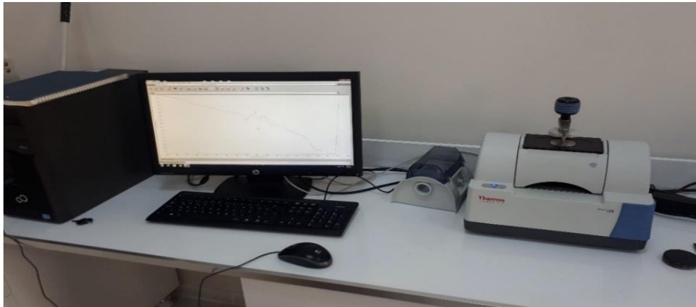
Şekil 4.11. FTIR analizleri için kullanılan Thermo scientific- Nicolet is50 cihazı
