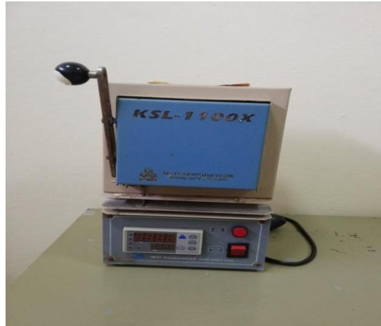
Şekil 4.5. Numunelerin sinterlenmesinde kullanılan ısıtım fırını
