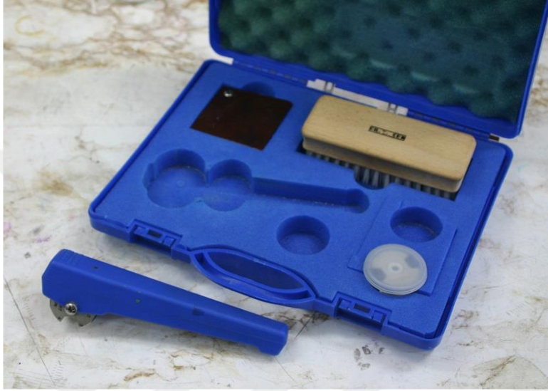
Şekil 4.29. Erichsen marka Cross Hatch Cutter Model 295 tutunma testi aparatı
