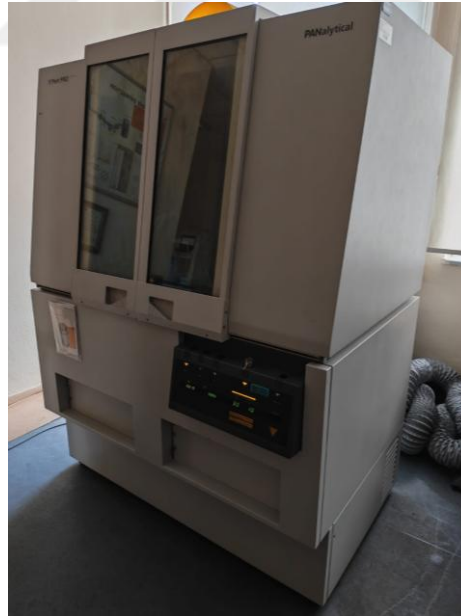
Şekil 3.14. PANalytical X'Pert PRO model bir X-ışını difraktometresi (XRD) cihazı
