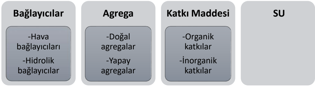
Şekil 1.2. Tarihi yapı harçlarını oluşturan bileşenler
