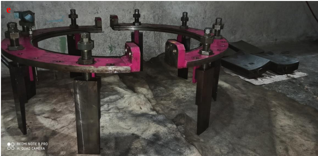
Resim 3.15.e. Türbin kılavuz yatak lokmalarının montaj bloğu
