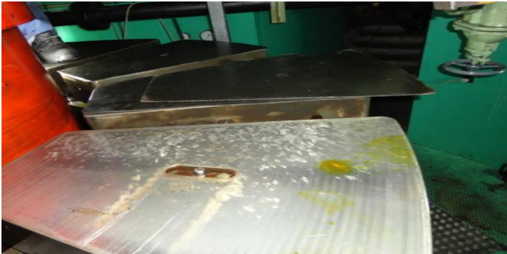
Resim 3.12. Hasar görmüştaşıyıcı yatak petleri
