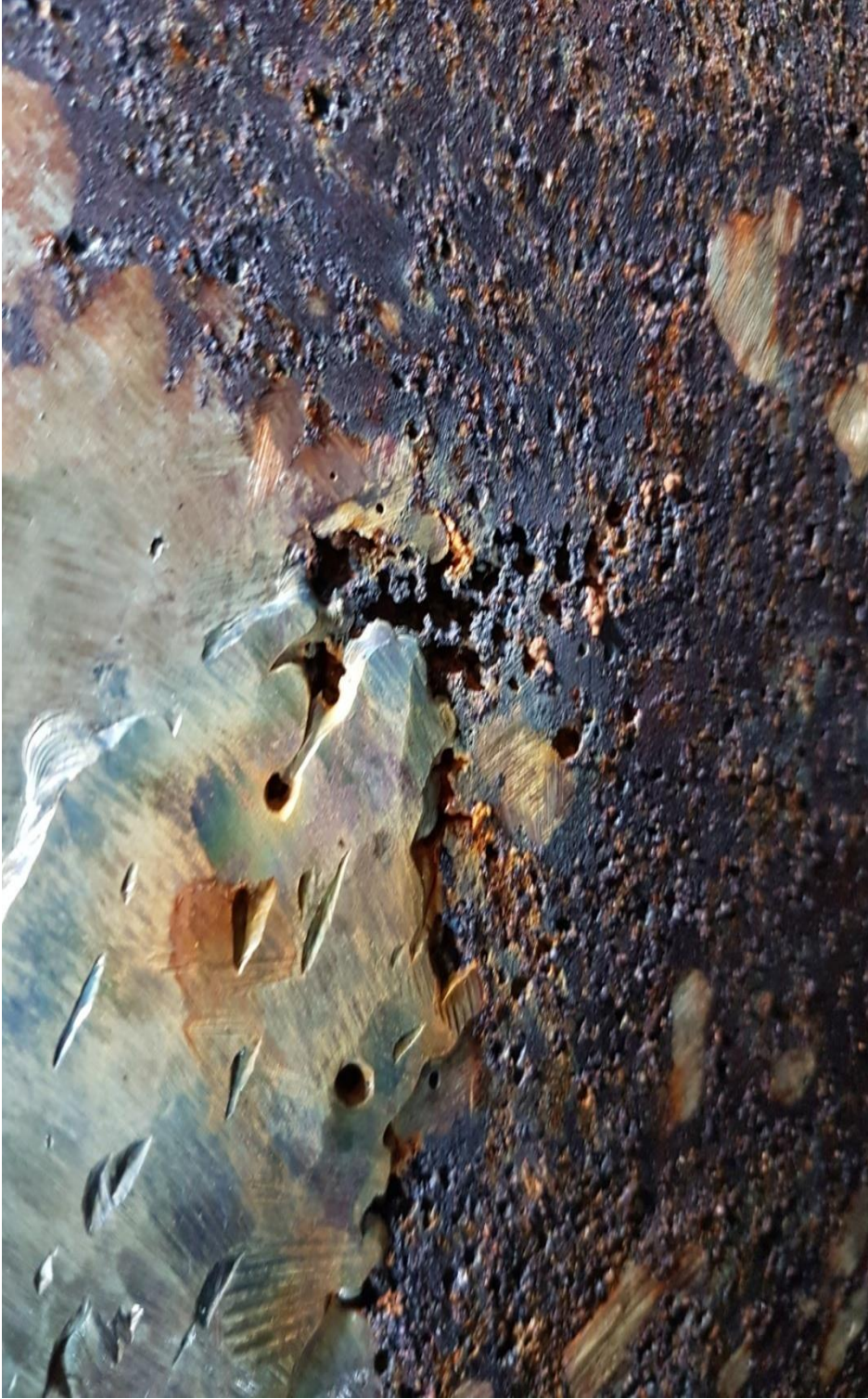
Resim 3.4. Kavitasyon olayının oluřtuđu francis türbin çarkı
