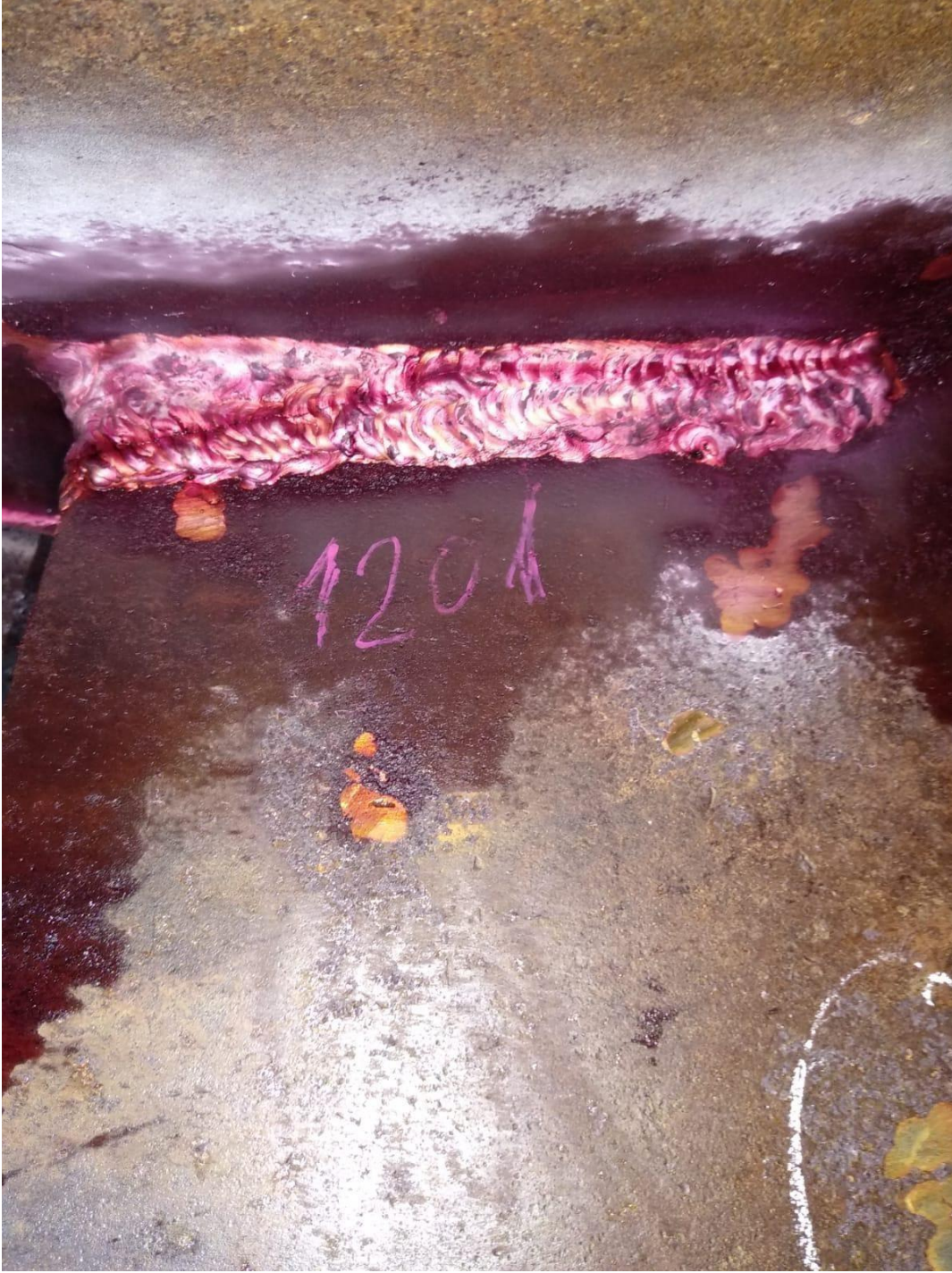
Resim 3.5. Kavitasyon olayının oluřtuđu ark kanat kaynak atlađının boya yntemi ile tespiti
