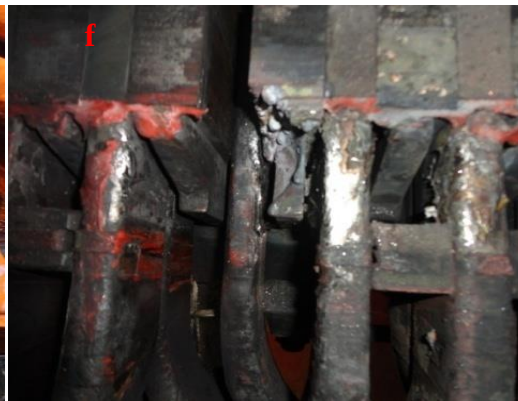
Resim 4.1.e. Stator sac paketi arızası
