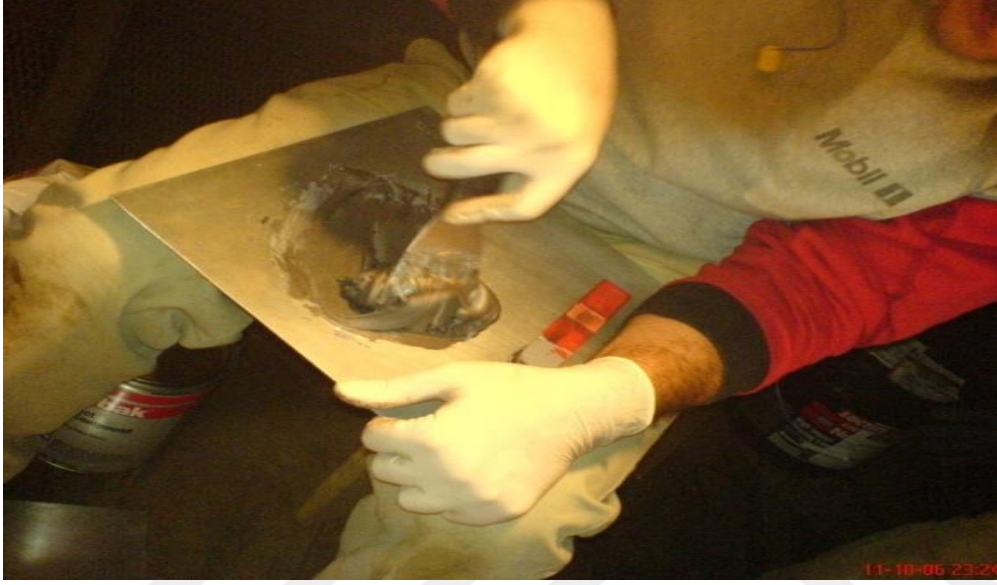
Resim 3.7. Kaplama malzemesinin hazırlanması ve çark yüzeyine uygulanması
