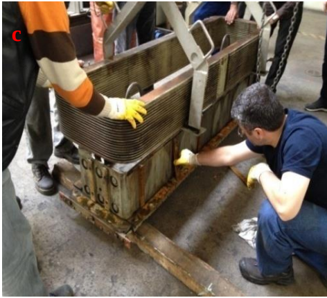
Resim 4.3.c. Rotor kutubu ve bakım çalışması
