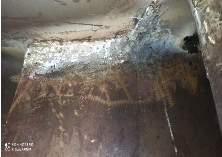
Resim 3.6. Kavitasyon onarım çalışması sonrası çark yüzeyi
