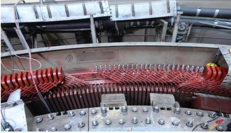
Resim 4.4. Arızalı sargılar çıkartıldıktan sonraki durum
