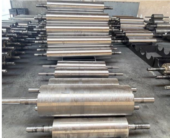
Şekil 3.1. Değirmen vals silindirleri savurma döküm sonrası imalat aşamaları.
