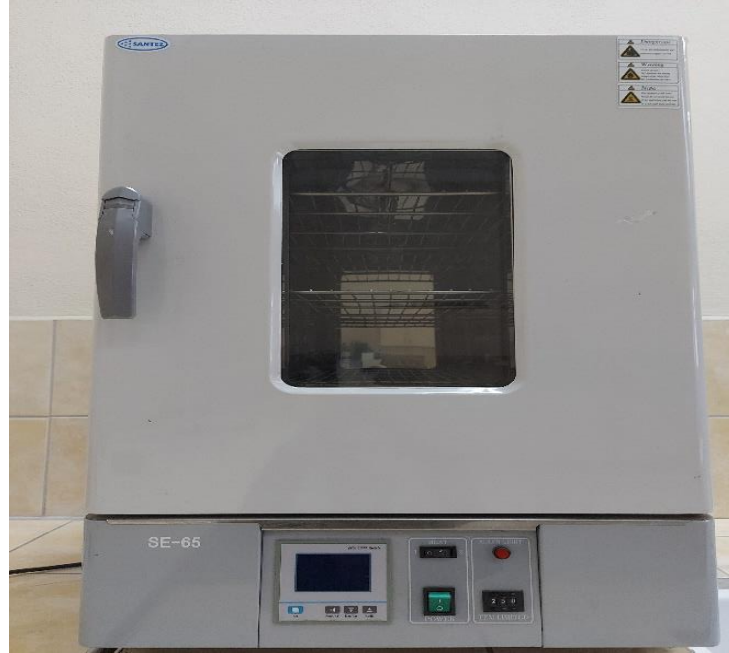
Şekil 9.3. Kurutma işleminin yapıldığı etüv fırını
