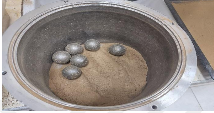
Şekil 9.2. Badem kabukları ve çay tesis atıklarının öğütüldüğü değirmen
